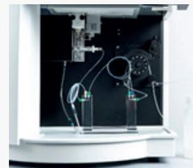
Abbildung 6: Kalibrierfunktion für die analytische Linie von Hg bei 184 nm unter Verwendung von ICP-OES, basiert auf der Reduktion von Quecksilberionen mittels NaBH<sub>4</sub> (links). Rechts sieht man das HS PQ Pro in der Probenkammer des PQ 9100 Elite.
