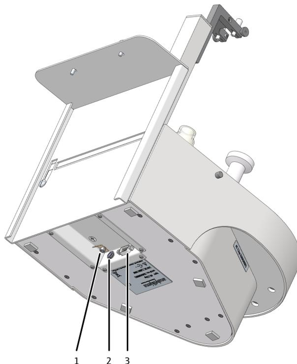
**Fig. 21 Raccords sur le dessus du distributeur d'échantillons**
