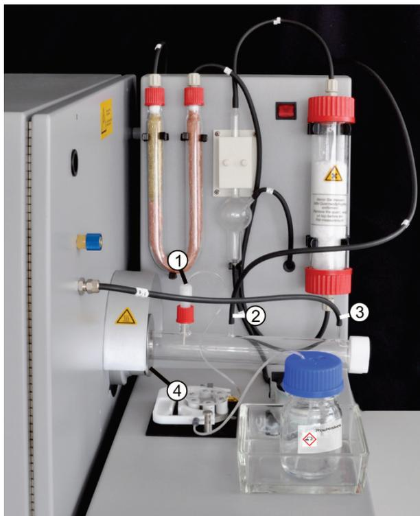
4. 将酸容器和滴水盘放在一边。小心地将泵软管擦干净。
