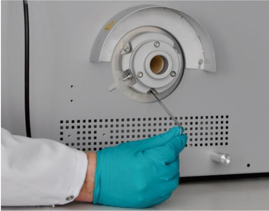
4. 将带有气闸的陶瓷管插入右侧的 multi EA 4000。如果陶瓷管卡住，请稍微旋转陶瓷管，无需施加压力，再推一推陶瓷管。
