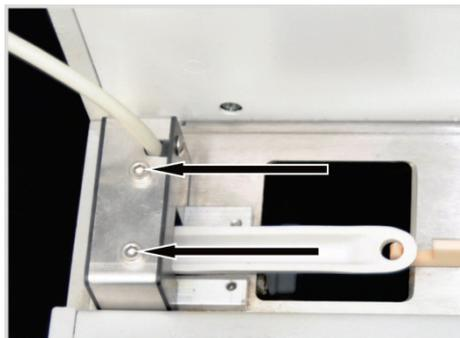
1. 将舟用传感器从左滑到 FPG 48 的短导轨上。
