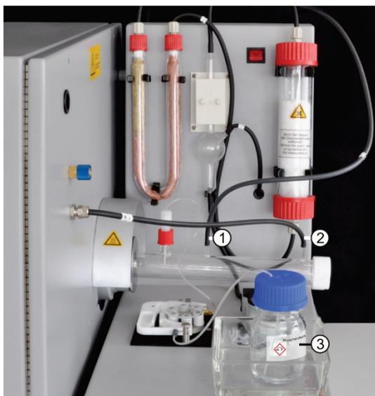
8. 将带有 72 号软管的测量气出口 (1) 连接到 TIC 固体模块背面冷却盘管的顶端。
