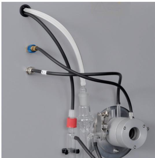
11. 将测量气体软管（透明）和旁路软管（黑色）穿过 multi EA 4000 中的通道。如有必要，用镊子将软管从通道的另一端拉出。
