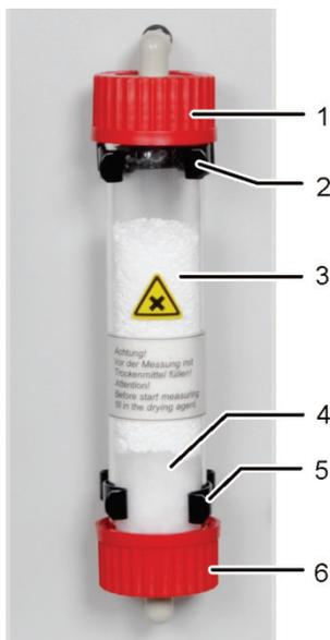
1. 拆下玻璃管上的螺旋盖。
