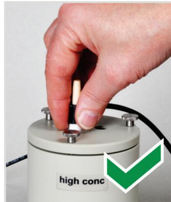
从顶部握住电极，将电极直接向上拉出盖子。
