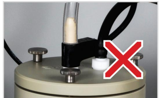
如果你将软管推到电极上太多，它会卡在电极上。拔下软管时，电极可能会断裂！
