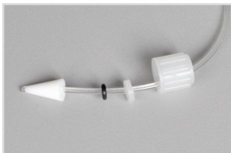
4. 从磨损的泵软管上拉下密封元件和白色活接螺母。
