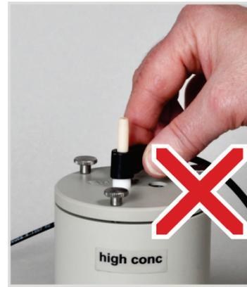
请勿拉动和摇晃电气连接的侧面连接套管。套管的连接会断开（从外面看不到）！
