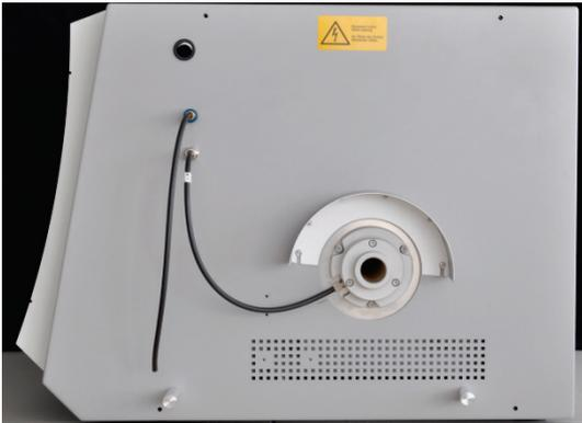
6. 将氧气软管（17 号软管）连接到气闸上。
