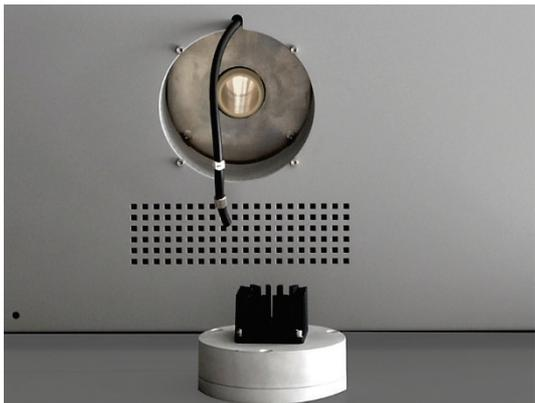
10. 将集尘器放在陶瓷管上，并将其与气体接头朝上对齐。将集尘器轻轻靠在陶瓷管上，向陶瓷管轴方向按压，直到集尘器滑到陶瓷管上并且无法再移动。
