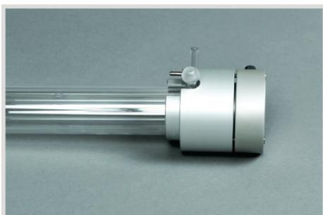
1. 在石英管中填充大约 2.5 厘米的石英棉，然后将棉塞推入管的末端。
