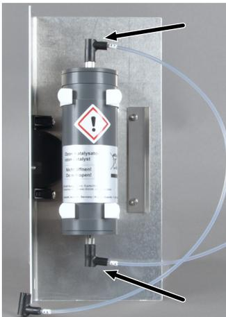
**Fig. 24** Destrucción química de ozono en la solapa de inspección extraída; los conectores FAST que deben retirarse están marcados con flechas.
