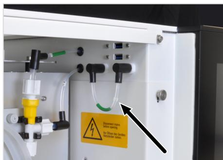
**Fig. 23 Puente de mangueras (manguera 7)**
