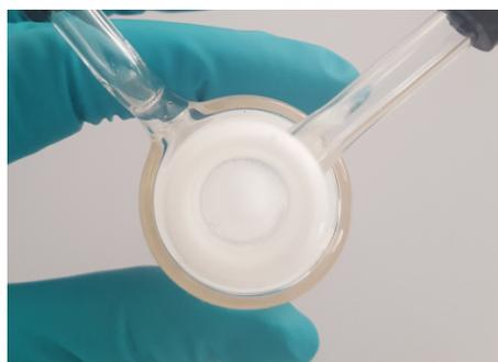
¡NOTA! El tapón no debe cerrar la ranura en el fondo del tubo interior. El tapón debe cubrir toda la sección transversal del tubo interior. Visto desde arriba, la ranura del tubo ya no debe ser visible.
