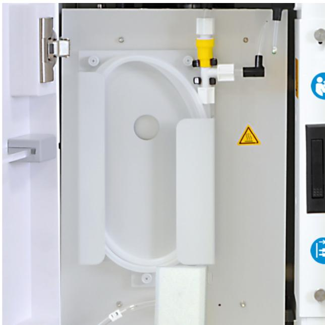
**Fig. 8** Secador de membrana
