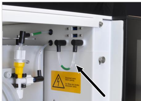
**Fig. 24 Puente de mangueras (manguera 7)**
