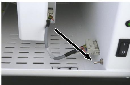
**Fig. 23 Interruptor de palanca para el cierre del conjunto de autoprotección**
