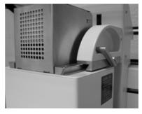
Abb. 23: Pipettierkopf abnehmen
