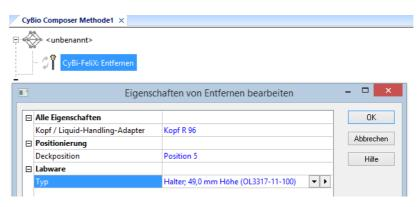
Abb. 42: Ablegen eines LH-Adapters (ggf. mit Spitzen, auf die Verwendung eines geeigneten Halters achten)
