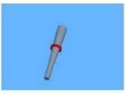
Nehmen Sie den O-Ringführungsstift mit den aufgezogenen O-Ringen, stekken Sie dieses in die vorgesehene Öffnung und drücken diesen bis zum Anschlag in die Öffnung.
