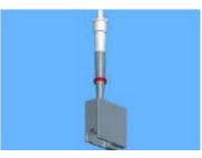
Schieben Sie langsam einen der aufgefädelten O-Ringe entlang den O-Ringführungsstift in Richtung Konus bis zu dessen Nut.
