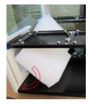
4. Transportsicherung der Kopfaufnahme einsetzen.
