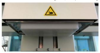
Abb. 46: Schutzmagazin (Transportsicherung) aufgenommen
