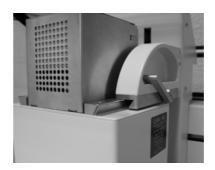
Abb. 20: Pipettierkopf aufschieben
