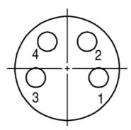
Abb. 52: Anschlussbelegung für den Anschluss ESTOP IN
