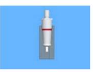
2. Falls dieser Versuch des O-Ring Entfernens nicht erfolgreich war, gibt es noch eine alternative Lösung für das Entfernen des O-Rings. Dazu drehen Sie das O-Ring Montagewerkzeug um. Hier befindet sich eine Spitze (an der Seite des O-Ringführungsstiftes), die ebenfalls zum Entfernen des O-Rings genutzt werden kann. Dazu drücken Sie die Spitze gegen den O-Ring und entfernen diesen anschließend.
