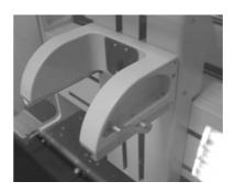
Abb. 19: Kopfaufnahme (Klemmhebel nach vorn geschwenkt)
