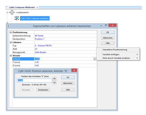
Abb. 32: Interaktive Positionierung zum Einstellen eines Versatzes
