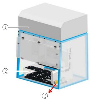
Abb. 48: Sicherheitswerkbank inkl. Türüberwachungsset<sup>1</sup>
