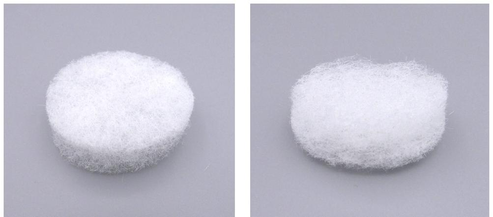
**Fig. 10 Lado más denso (izquierda) y menos denso (derecha) de la estera filtrante**
