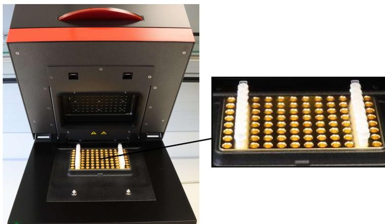
**Fig. 10** Posición de las tiras de 8 pocillos adicionales para la medición con pocas muestras
