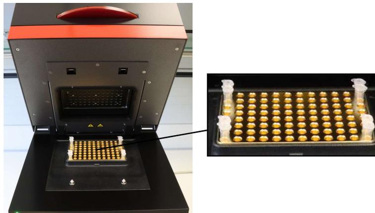
Fig. 9 Posición de los recipientes individuales adicionales para la medición con pocas muestras
