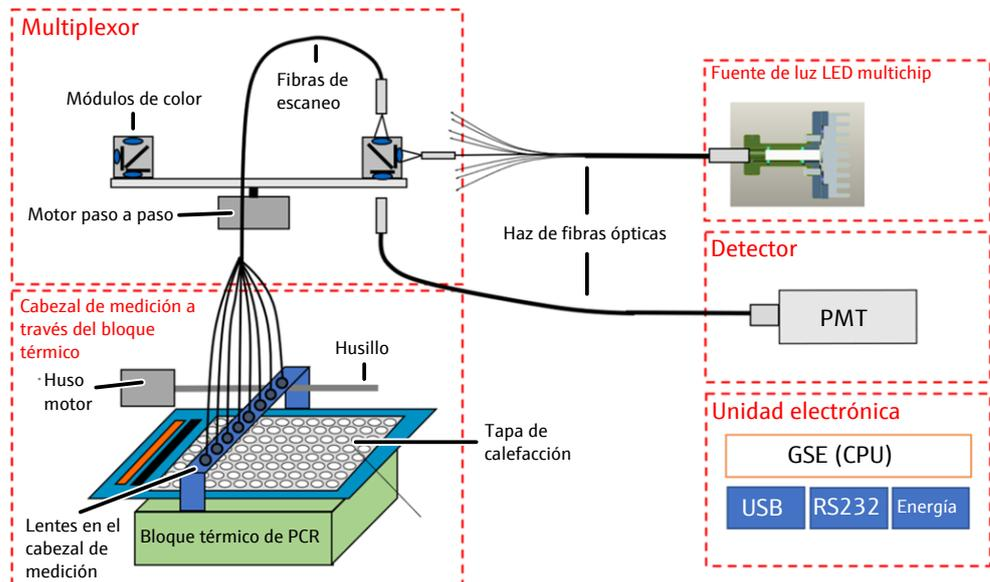
**Fig. 6 Diagrama esquemático del espectrómetro de fluorescencia**
