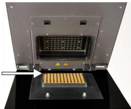
**Fig. 11** Posición A1 en el bloque de muestra
