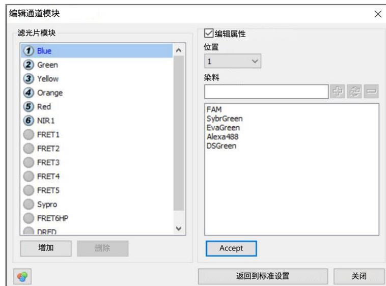
Fig. 12 Ventana de selección de módulos de color. Nota: A partir de la versión de software 4.1 solo se muestran los nombres de los módulos de color en la lista «Módulos de color», no el código de módulo completo.
