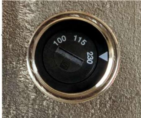
**Fig. 8 Selector de tensión en la parte inferior del equipo**
