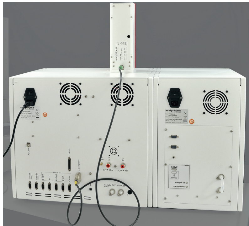
Abb. 5 Anschluss Autoinjector an den Analysator
