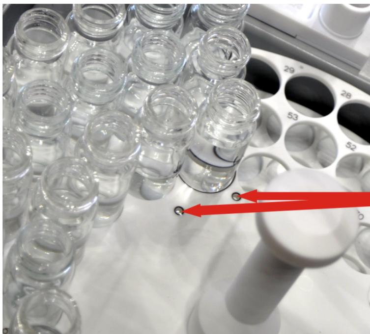
Fig. 46 Puntos de ajuste en la bandeja de muestras
