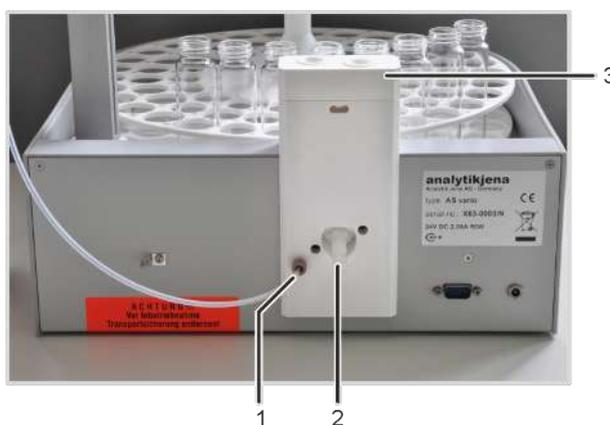
**Fig. 31 Lavado de cánulas en el modelo AS vario ER**
