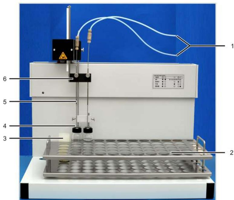
**Fig. 33 Automuestreador EPA Sampler**
