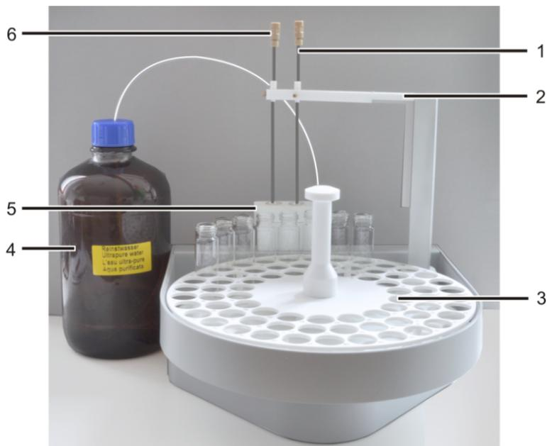
**Fig. 27 Estructura del automuestreador AS vario ER**
