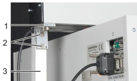
**Fig. 37 Monte el estribo del agitador**
