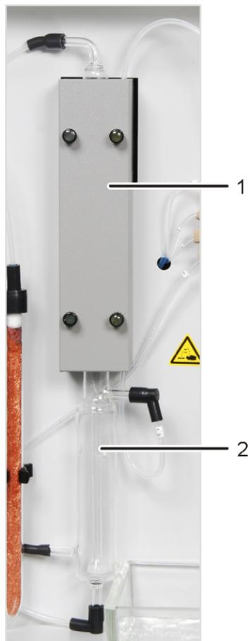
**Fig. 9 Módulo de condensación de TIC**
