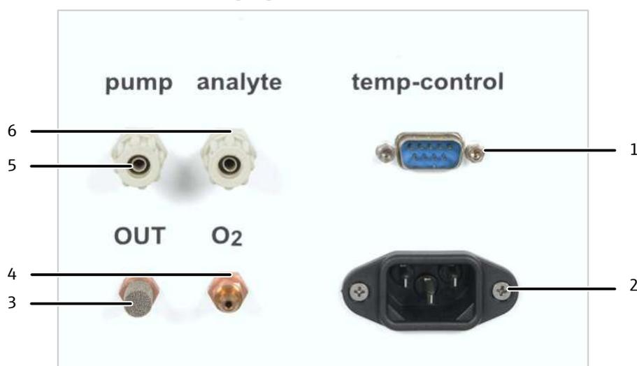
Fig. 25 Conexiones en el panel trasero del módulo de materia sólida
