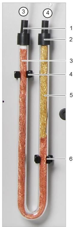
**Fig. 41 Sustitución de la trampa de halógenos**
