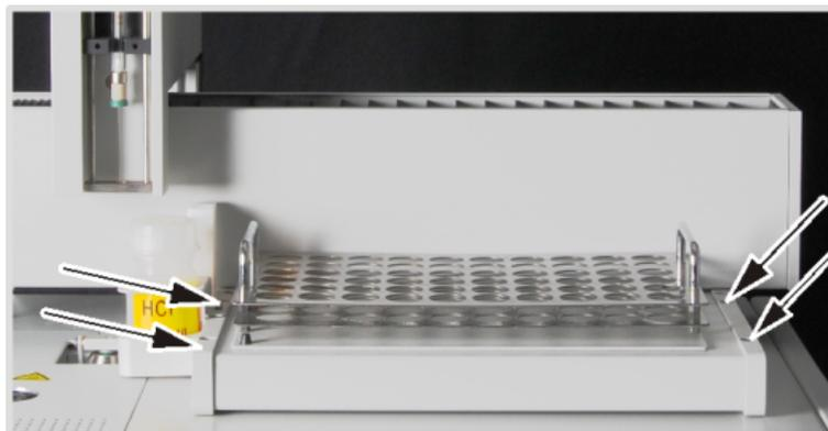
**Fig. 22 Conectar el automuestreador al analizador**
