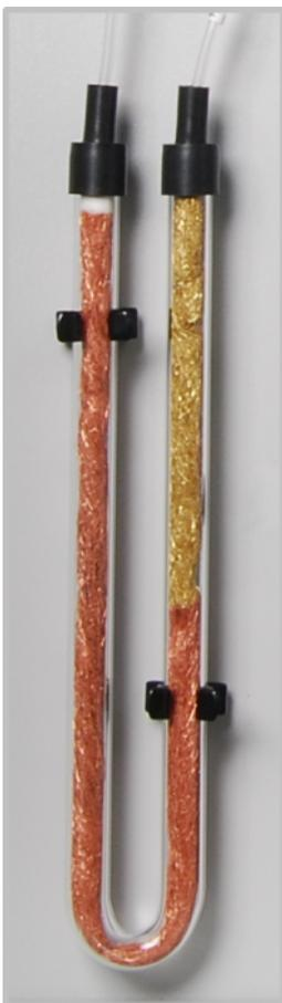
**Fig. 14 Trampa de halógenos**
