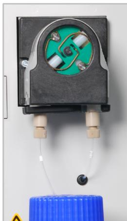
**Fig. 8 Bomba de ácido fosfórico**
