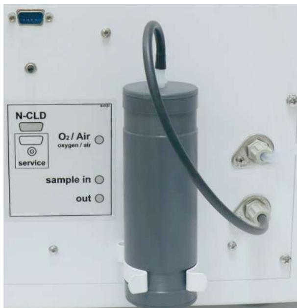
**Fig. 42 Sustitución del cartucho absorbedor**
