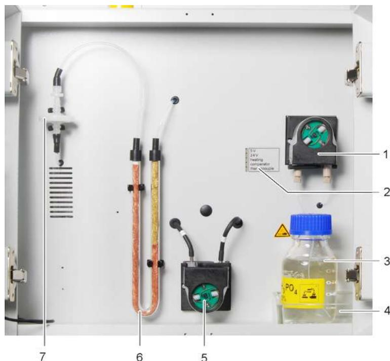
**Fig. 1 Analizador, puertas frontales abiertas**
