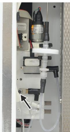
**Fig. 6** Ajuste del flujo de purga NPOC
