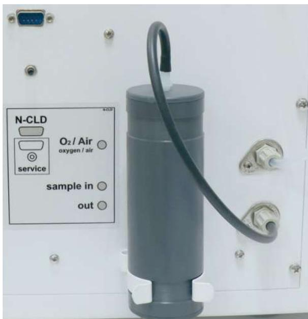
**Fig. 64 Sustitución del cartucho absorbedor**
