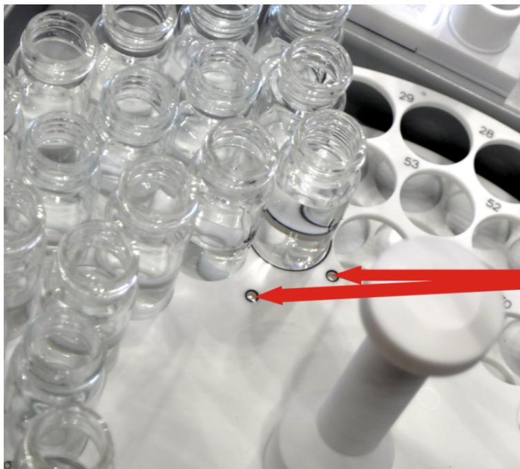
**Fig. 52 Puntos de ajuste en la bandeja de muestras**
