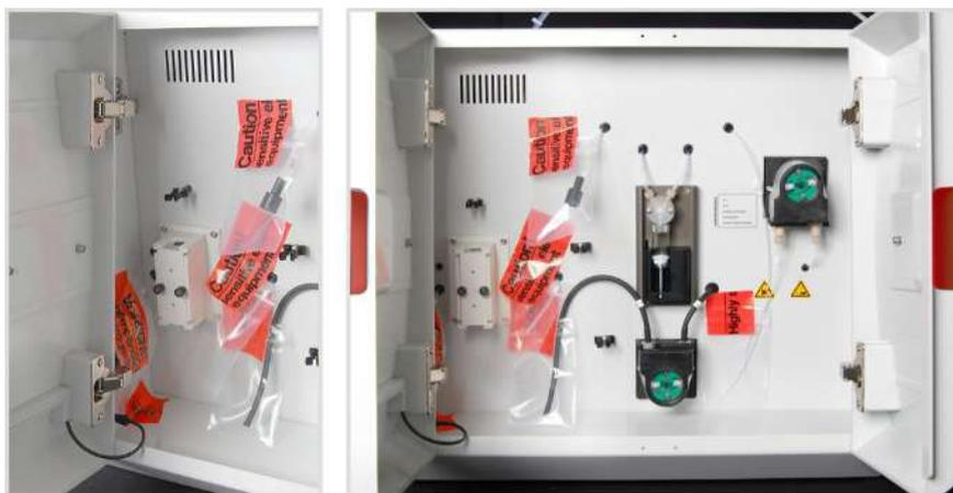
**Fig. 65 Componentes de detrás de las puertas frontales asegurados para el transporte**
