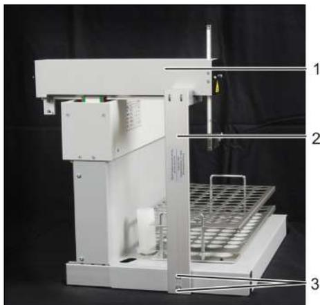
**Fig. 40 Protección para el transporte**
