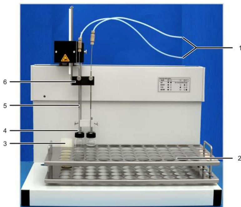
**Fig. 37 Automuestreador EPA Sampler**
