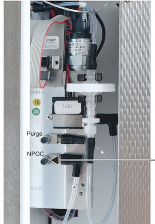
**Fig. 5 Ajuste del flujo de purga NPOC**
