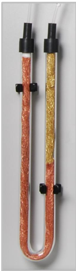
**Fig. 14 Trampa de halógenos**
