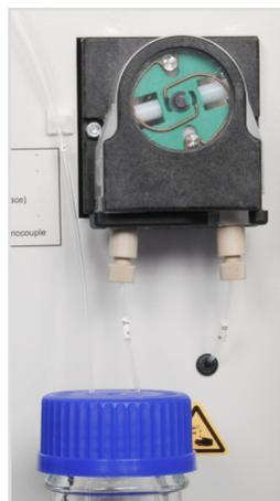
**Fig. 7 Bomba de ácido fosfórico**
