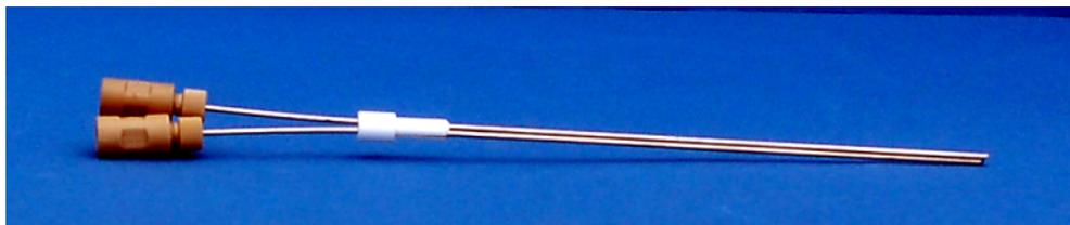
**Fig. 33 Casquillo con dos cánulas para el soplado no paralelo**
