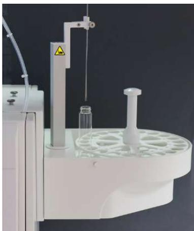
**Fig. 24 Automuestreador unido al analizador mediante un soporte**
