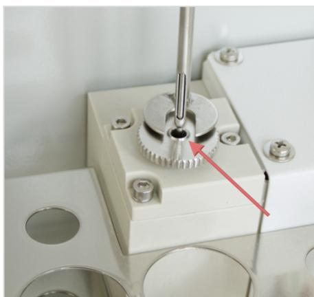
**Fig. 65 Ajuste las cánulas en el reactor POC**
