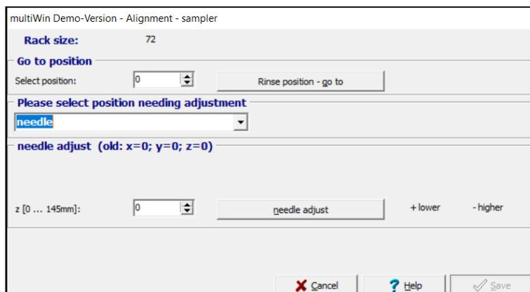
Fig. 57 Ajuste del automuestreador
