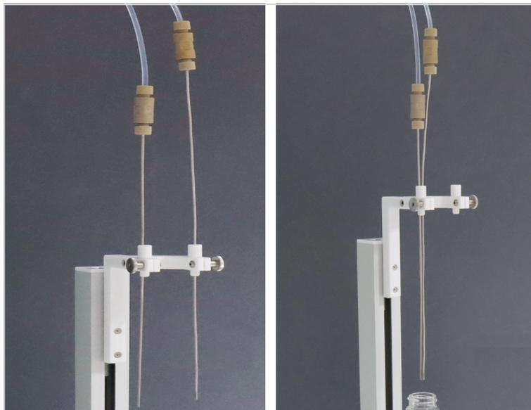
**Fig. 31 Soplado paralelo (izquierda) y secuencial (derecha)**
