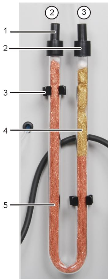
**Fig. 73 Sustitución de la trampa de halógenos**
