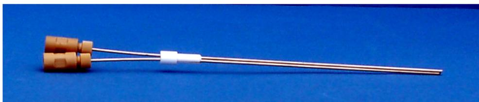
**Fig. 35 Casquillo con dos cánulas para el soplado no paralelo**
