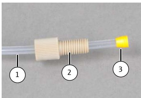
**Fig. 29 Conexión fingertight**
