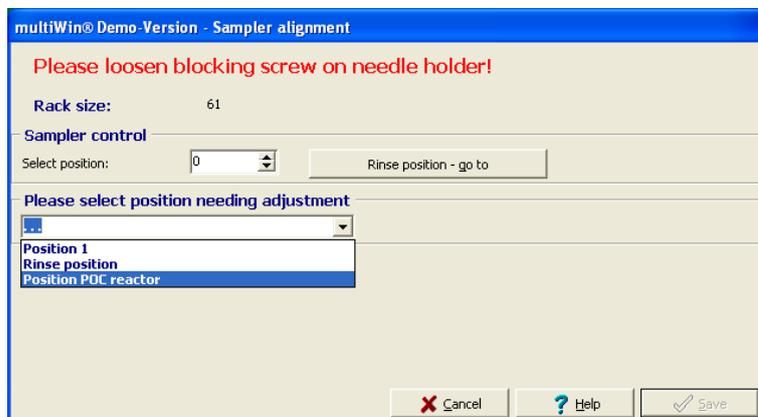
**Fig. 63 Ajuste del automuestreador**
