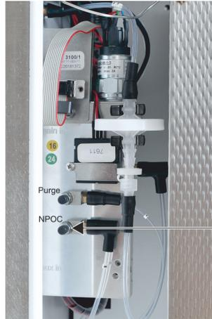
**Fig. 5 Ajuste del flujo de purga NPOC**
