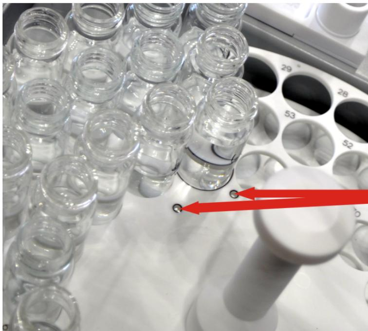
**Fig. 58 Puntos de ajuste en la bandeja de muestras**
