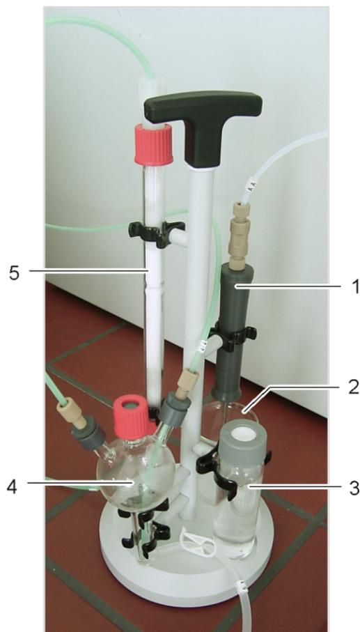
**Fig. 47 Módulo POC para el funcionamiento manual**
