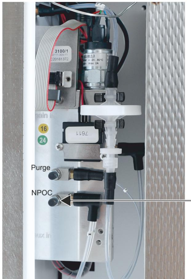
Fig. 68 Ajuste del flujo de purga NPOC
