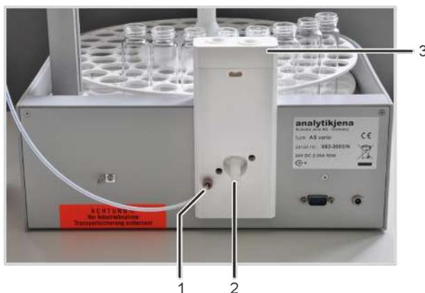
**Fig. 37 Lavado de cánulas en el modelo AS vario ER**
