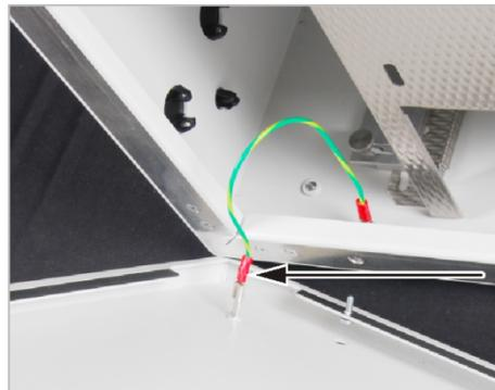
**Fig. 66 Conexión a tierra de protección en la pared lateral**
