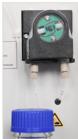
**Fig. 7 Bomba de ácido fosfórico**
