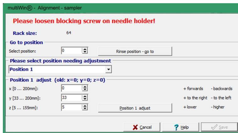
Fig. 60 Ajuste del automuestreador
