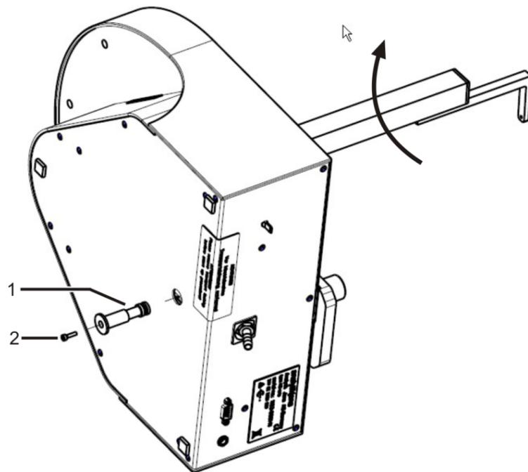
**Fig. 76 Asegurar el automuestreador para el transporte**
