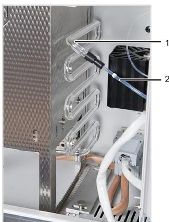
Fig. 11 Serpentín de condensación
