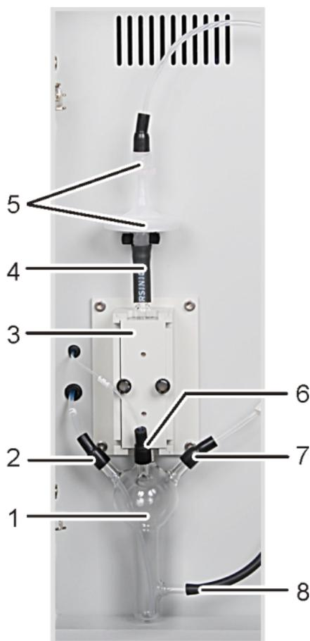
**Fig. 12 Módulo de condensación de TIC**
