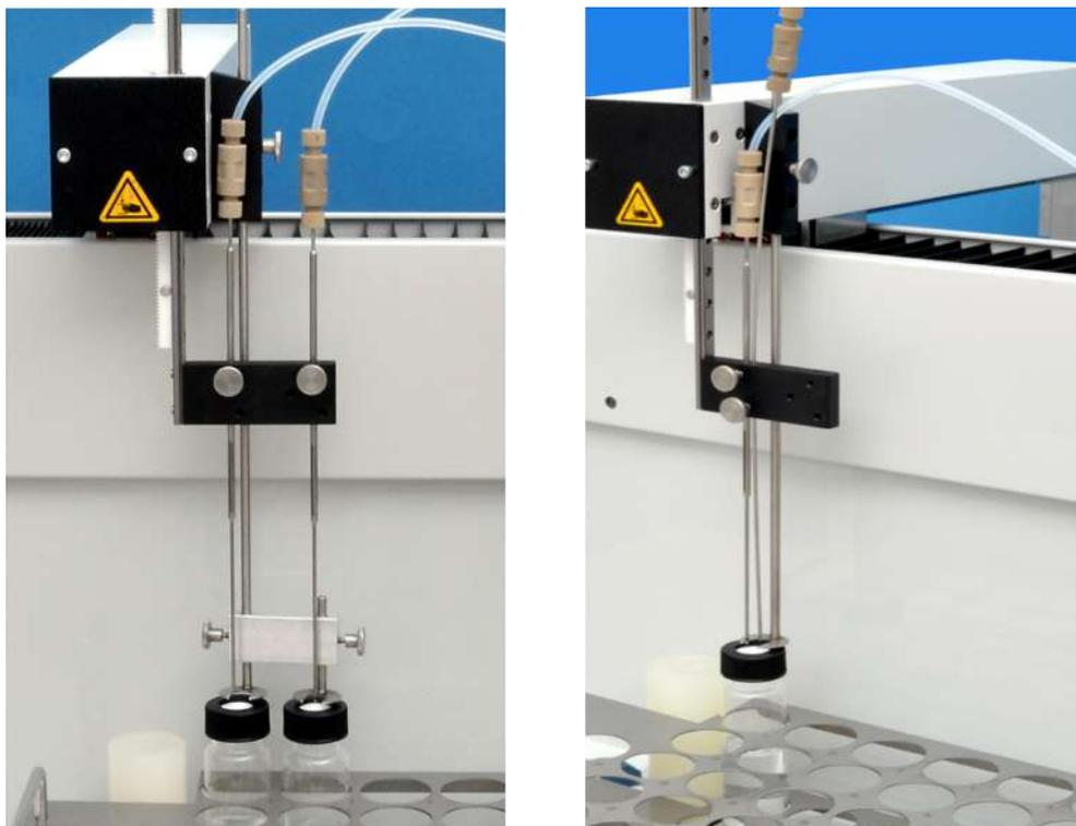
**Fig. 45 Posición de la cánula para las mediciones de NPOC con soplado paralelo (izquierda) y no paralelo (derecha)**
