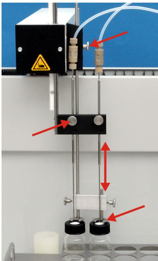
Fig. 59 Instalar cánulas (aquí: 2 cánulas para el soplado paralelo)
