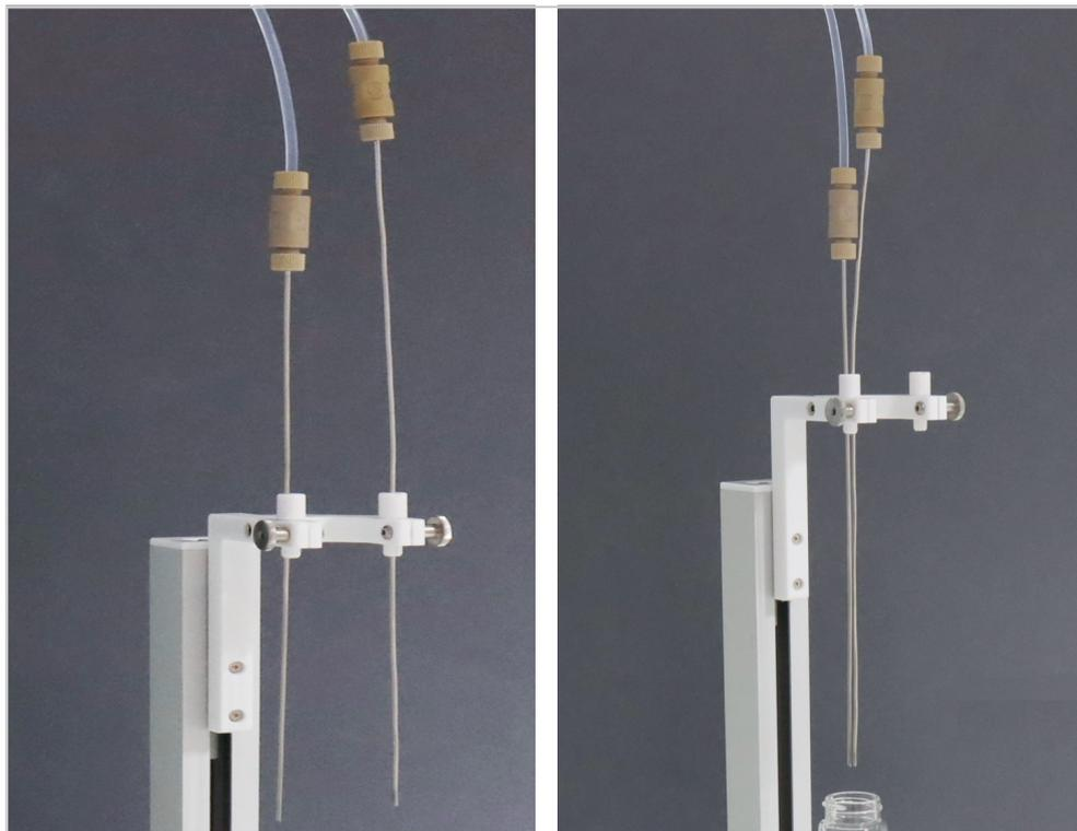
**Fig. 25 Soplado paralelo (izquierda) y secuencial (derecha)**
