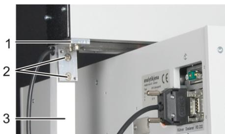
**Fig. 44 Monte el estribo del agitador**
