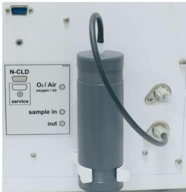
**Fig. 74 Sustitución del cartucho absorbedor**
