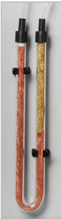
**Fig. 14 Trampa de halógenos**
