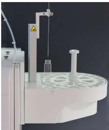
**Fig. 26 Automuestreador unido al analizador mediante un soporte**
