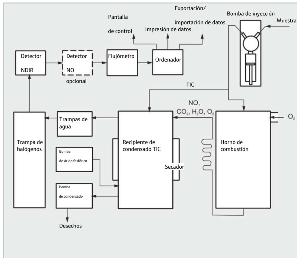
**Fig. 18 Principio de funcionamiento**
