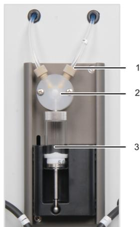
**Fig. 3 Bomba de inyección**
