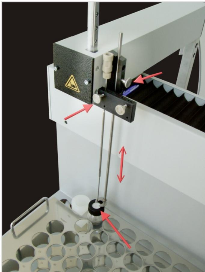
**Fig. 62 Instale las cánulas y el soporte**
