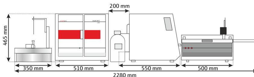
Fig. 20 Necesidad de espacio del sistema de medición modular multi N/C 3100 duo
