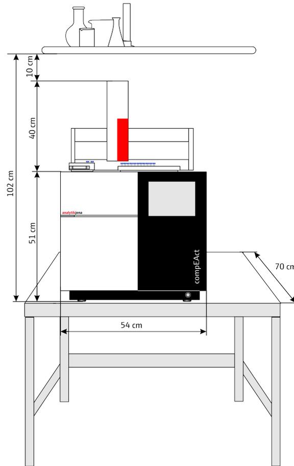
Fig. 15 Esquema de instalación del equipo con automuestreador
