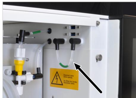
**Fig. 22** Puente de mangueras (manguera 7)
