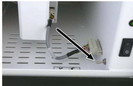
**Fig. 21** Interruptor de palanca para el cierre del conjunto de autoprotección
