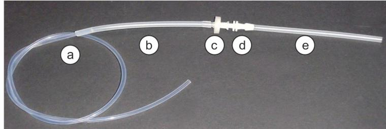
**Fig. 20** Juego de mangueras para la comprobación del flujo
