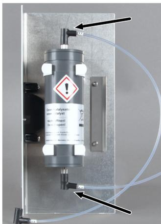
**Fig. 23** Destrucción química de ozono en la solapa de inspección extraída; los conectores FAST que deben retirarse están marcados con flechas.
