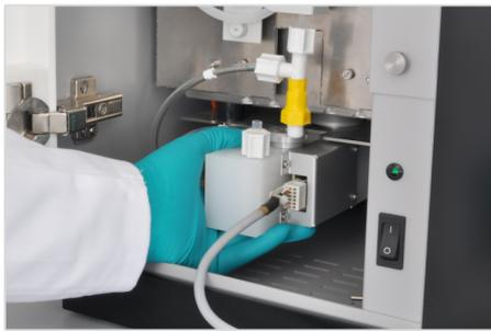
▶ Extraiga el conjunto de autoprotección del soporte situado bajo el horno de combustión.
