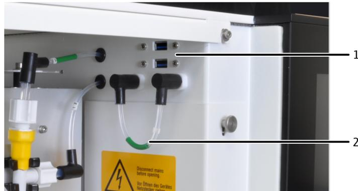
**Fig. 17 Interfaces USB y puente de mangueras en la trayectoria del gas detrás de la puerta principal**
