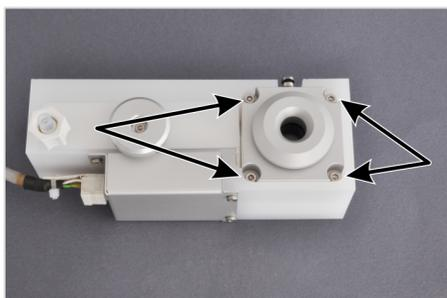
▶ Desenroscar los 4 tornillos de la junta neumática en el conjunto de autoprotección.
