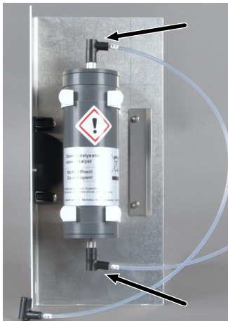
Abb. 23 Chemischer Ozonvernichter an herausgezogener Revisionsklappe; die abzunehmenden FAST-Verbinder sind durch Pfeile gekennzeichnet
