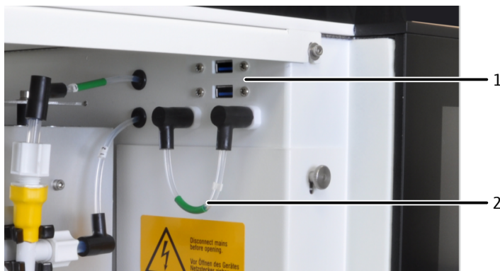
Abb. 18 USB-Schnittstellen und Schlauchbrücke im Gasweg hinter Fronttür
