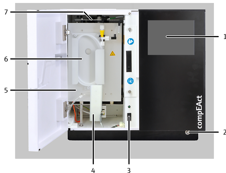
Abb. 3 Hauptkomponenten des Gerätes
