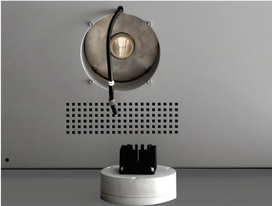
5. Die Staubfalle öffnen. Dafür die 3 Innensechskantschrauben auf der Seite der Kühlrippen lösen.
