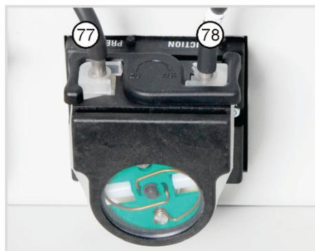
8. Das Laufband um den Pumpenkörper legen.
