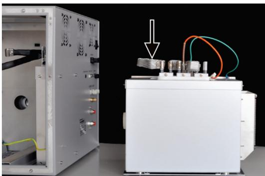
5. Den Schutzleiter (5) von der Ofenpatrone (4) und dem L-förmigen Halteblech (3) lösen.
