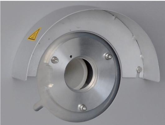
5. Kupplungsstück mit drei Innensechskantschrauben auf der rechten Seite des Grundgeräts montieren. Darauf achten, dass das Führungsloch über dem Loch im Grundgerät liegt und die Aussparung zur Frontseite zeigt.
