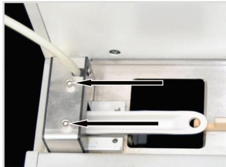
1. Den Schiffchensensor von links auf die kurze Führungsschiene des FPG 48 schieben.
