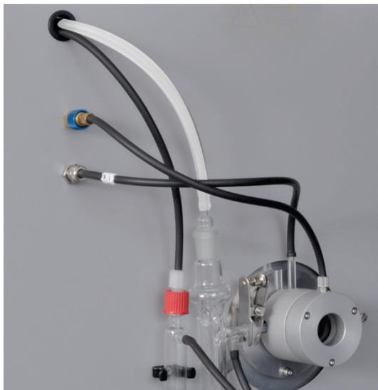
11. Den Messgasschlauch (farblos) und den Bypass-Schlauch (schwarz) durch den Kanal im multi EA 4000 schieben. Ggf. die Schläuche mit einer Pinzette aus dem anderen Kanalende ziehen.
