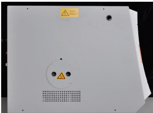
Wenn die Gasschleuse bereits installiert ist, kann das Keramikrohr auch von der linken Seite, über die Öffnung für die Staubfalle in das Grundgerät eingesetzt werden.
