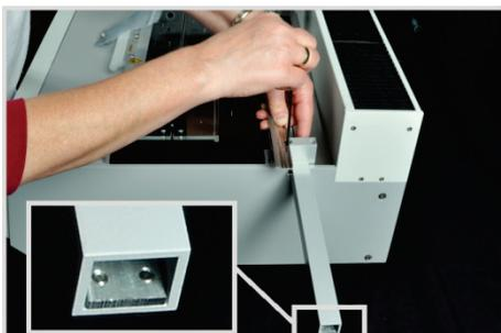
1. Das Anschlagblech der Führungsschiene (1) abschrauben.
