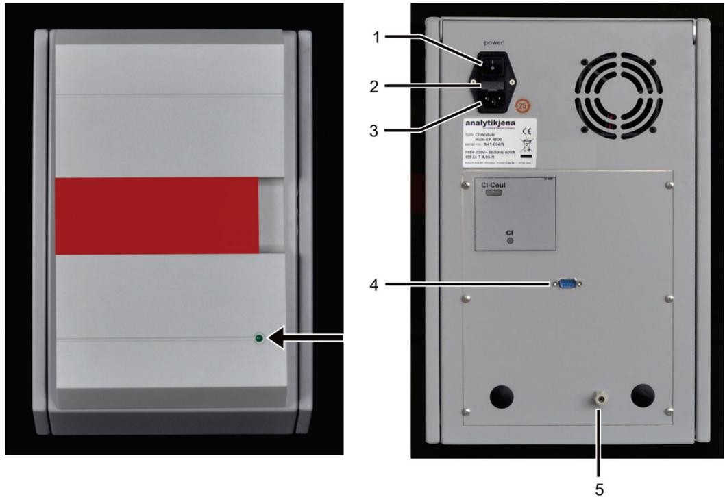
Bild 18 Anschlüsse des CI-Modul in Kombination mit einem C/S-Modul
