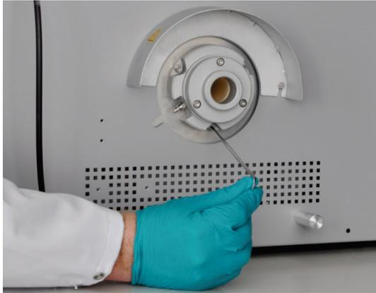
4. Das Keramikrohr mit Gasschleuse auf der rechten Seite in den multi EA 4000 einsetzen. Wenn sich das Rohr verhakt, in einer leichten Drehbewegung, ohne Druck weiter schieben.
