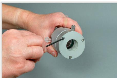
4. Das Gegenstück der Gasschleuse mit den drei dazugehörigen Innensechskantschrauben befestigen. Die Schrauben dabei reihum gleichmäßig festziehen.
