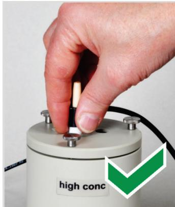
Umfassen Sie die Elektrode von oben und ziehen Sie die Elektrode gerade nach oben aus dem Deckel.
