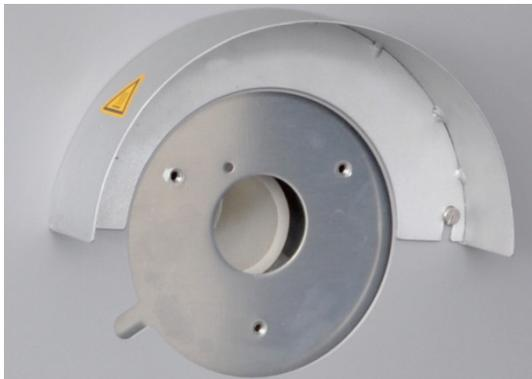
1. Falls noch nicht erfolgt, Staubfalle über die Öffnung in der linken Seitenwand des Grundgeräts entfernen.
