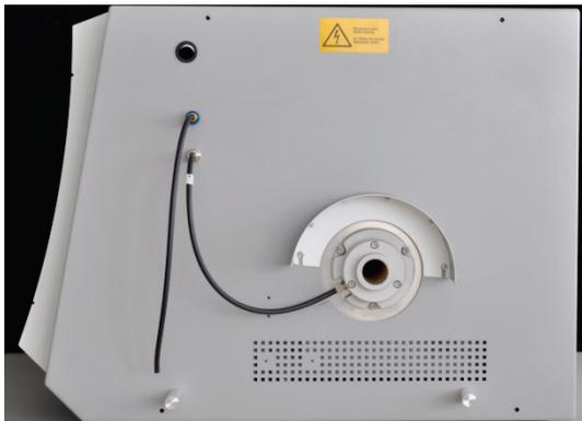
6. Sauerstoffschlauch (Schlauch Nr. 17) an der Gasschleuse befestigen.
