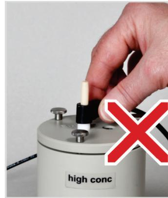
Ziehen und ruckeln Sie nicht an der seitlichen Anschlusschülse für die elektrischen Verbindungen. Die Anschlüsse in der Hülse brechen (von außen nicht sichtbar)!
