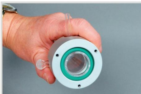
3. Das Quarzrohr in den Andruckring schieben, sodass die Gasabgänge in die Schlitz des Ringes ragen.
