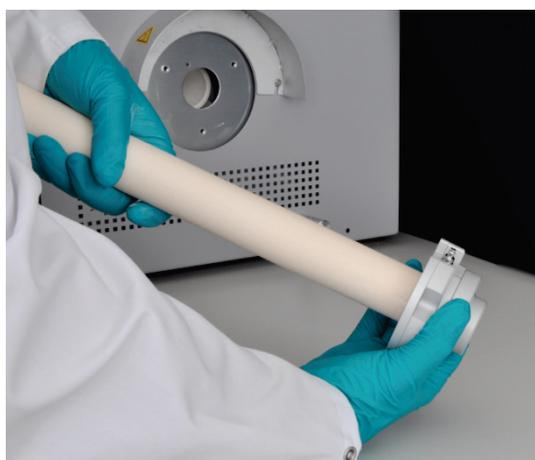
3. Das Keramikrohr bis zum Anschlag in die Gasschleuse schieben.
