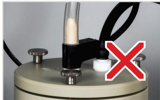
Wenn Sie den Schlauch zu weit auf die Elektrode schieben, saugt er sich an der Elektrode fest. Beim Herunterziehen des Schlauchs kann die Elektrode brechen!
