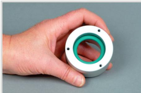
2. Den Dichtungsring in den Andruckring der Gasschleuse legen.
