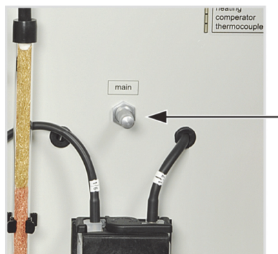
Imag. 5 Válvula de aguja para el ajuste del flujo del gas portador
