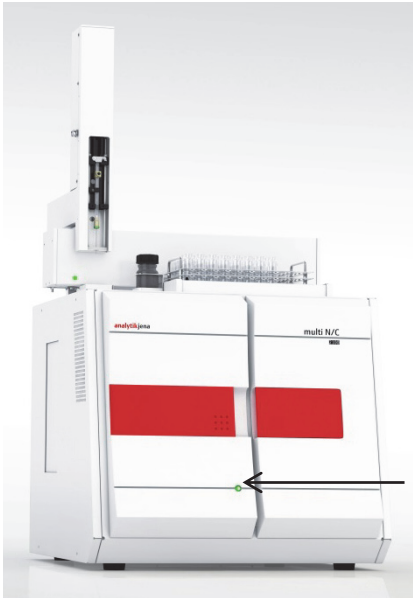
Imag. 15 Diodo LED para indicar la disponibilidad operacional
