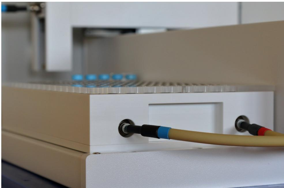
**Fig. 16 Bandeja de muestras calefactable: conexiones**
