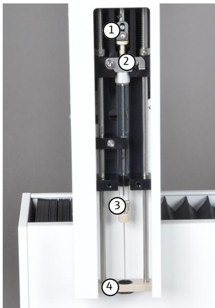
**Fig. 4 Seringue de dosage – installée dans la tête d'injection**
