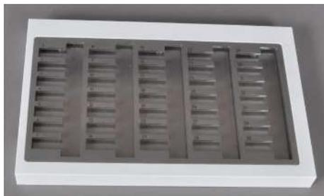
Fig. 8 Tablette porte-échantillons pour les échantillons AOX, solides et liquides hautement visqueux
