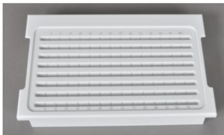
Fig. 10 Tablette porte-échantillons pour les échantillons AOX
