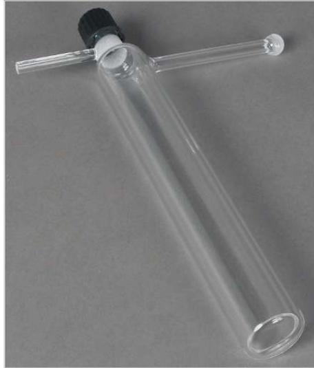
**Abb. 58 TOC-Verbrennungsrohr (ohne Füllung)**
