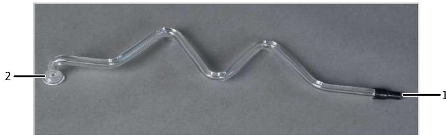
**Abb. 60 Kondensationsschlange**
