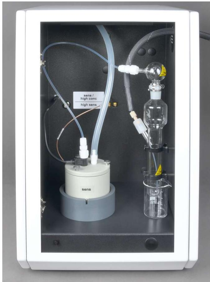
**Abb. 40 Gaseinleitung in die Messzelle "sensitive"**
