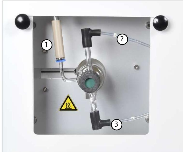
**Abb. 14** Anschlüsse am Verbrennungsrohr
