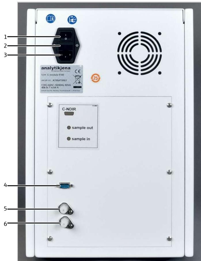
**Abb. 55** Rückseite des Kohlenstoffdetektors
