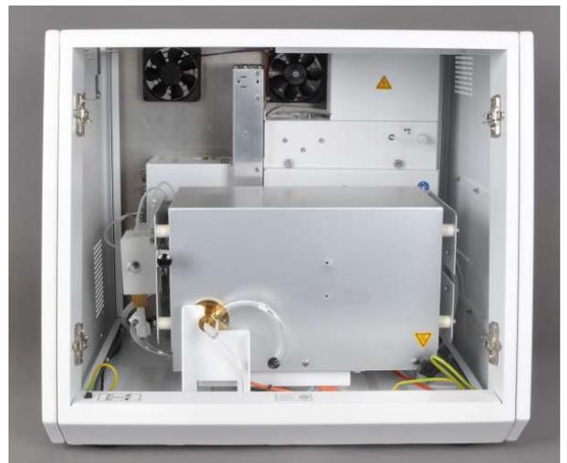
**Abb. 15** Verbrennungsofen im vertikalen und horizontalen Betriebsmodus
