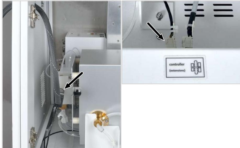
**Abb. 42 Anschluss der Gastransferleitung im Basismodul**
