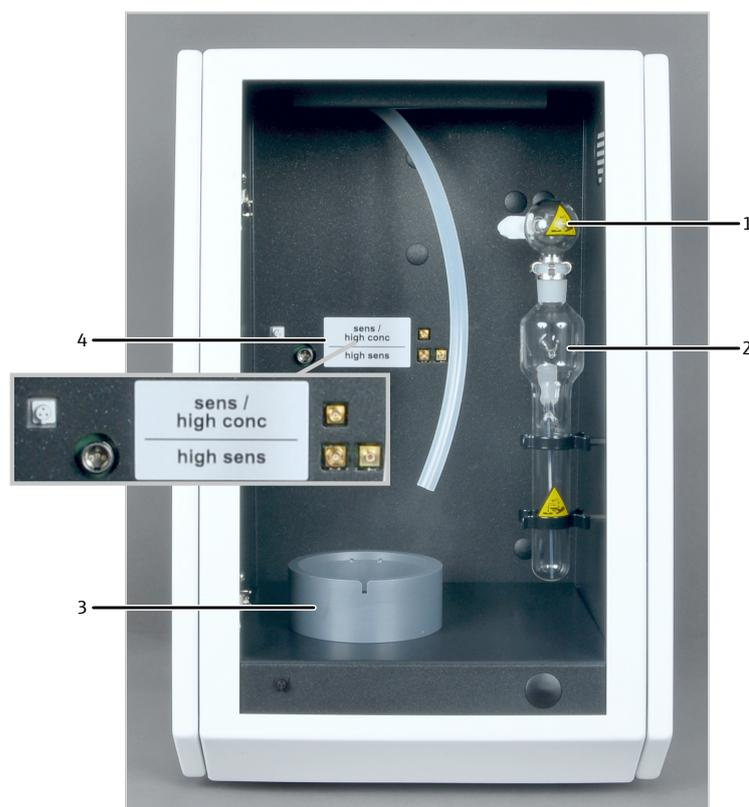
**Изобр. 25 Устройство детектора хлора (без измерительной ячейки)**
