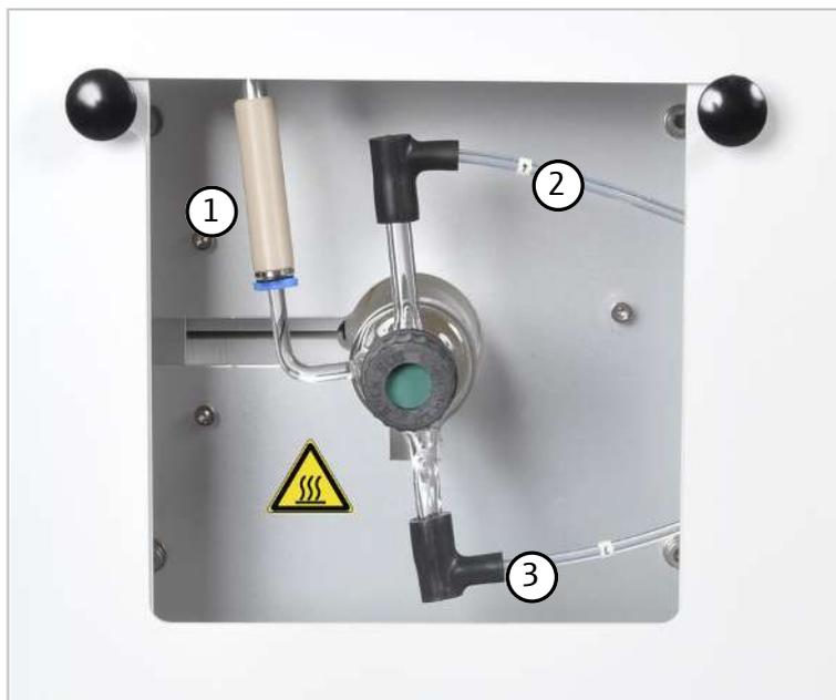
Изобр. 14 Точки подсоединения на трубке для сжигания
