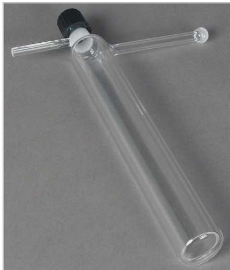
**Изобр. 58** TOC-трубка для сжигания (без наполнителя)
