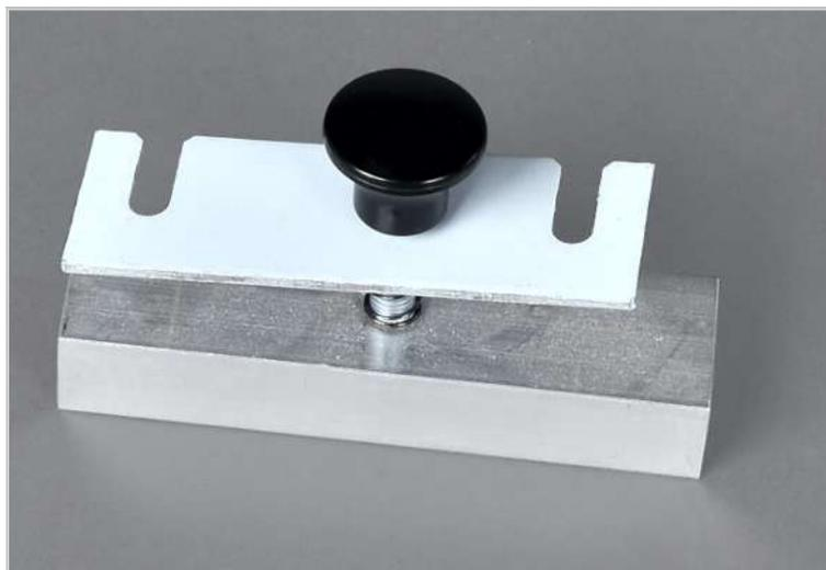
**Изобр. 59** Фиксатор TOC-трубки для сжигания
