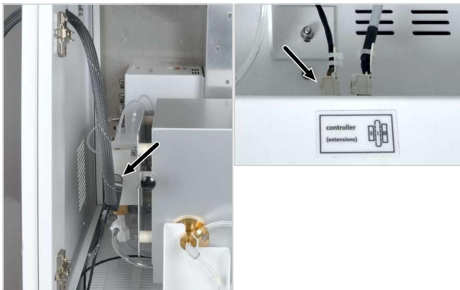
**Изобр. 42 Соединение линии переноса газа в базовом модуле**
