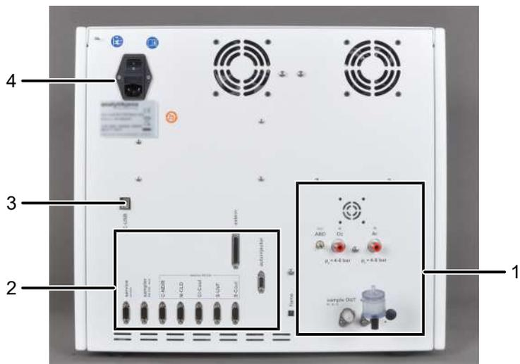
**Изобр. 5 Разъемы на задней панели прибора**
