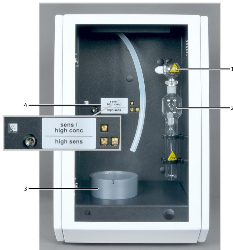
**Fig. 25 Conception du détecteur de chlore (sans cellule de mesure)**
