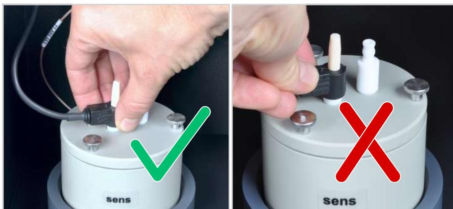
Fig. 72 Manipuler correctement l'électrode bifonctionnelle
