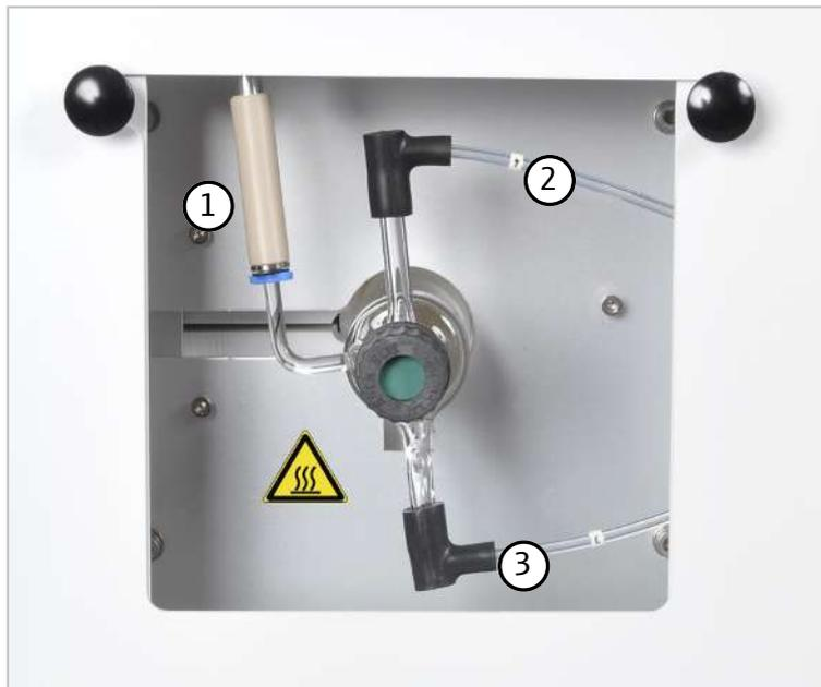
**Fig. 14 Raccords sur le tube de combustion**
