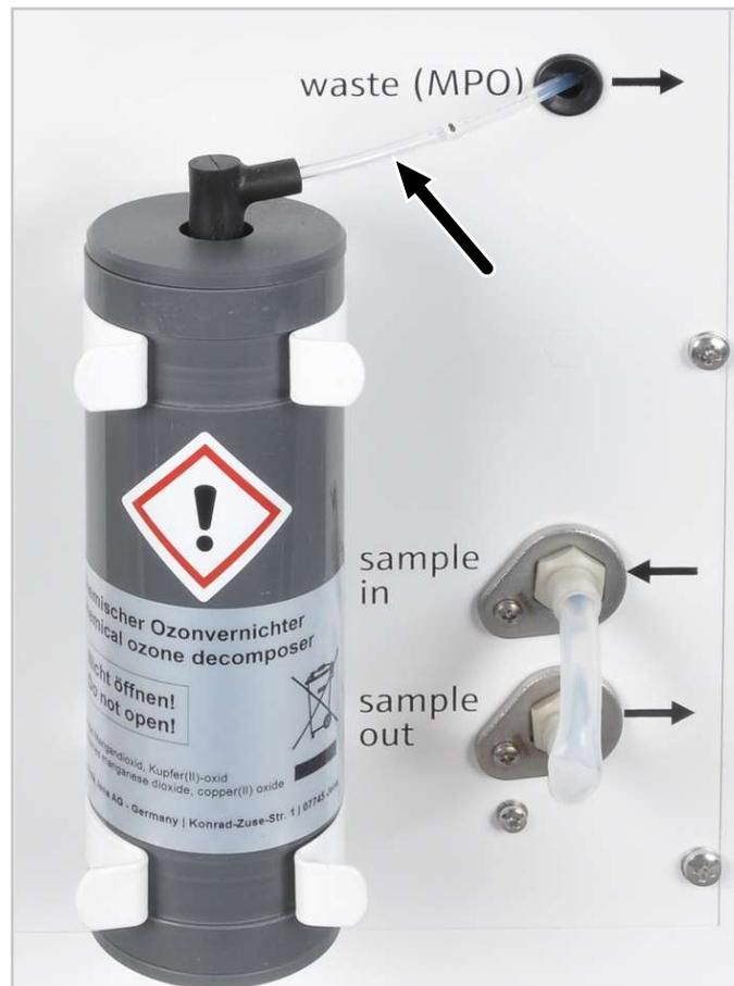
Fig. 73 Remplacer le destructeur chimique d'ozone
