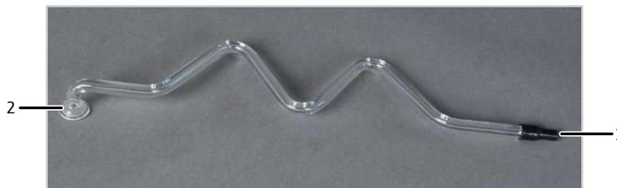
**Fig. 60 Serpentin de condensation**
