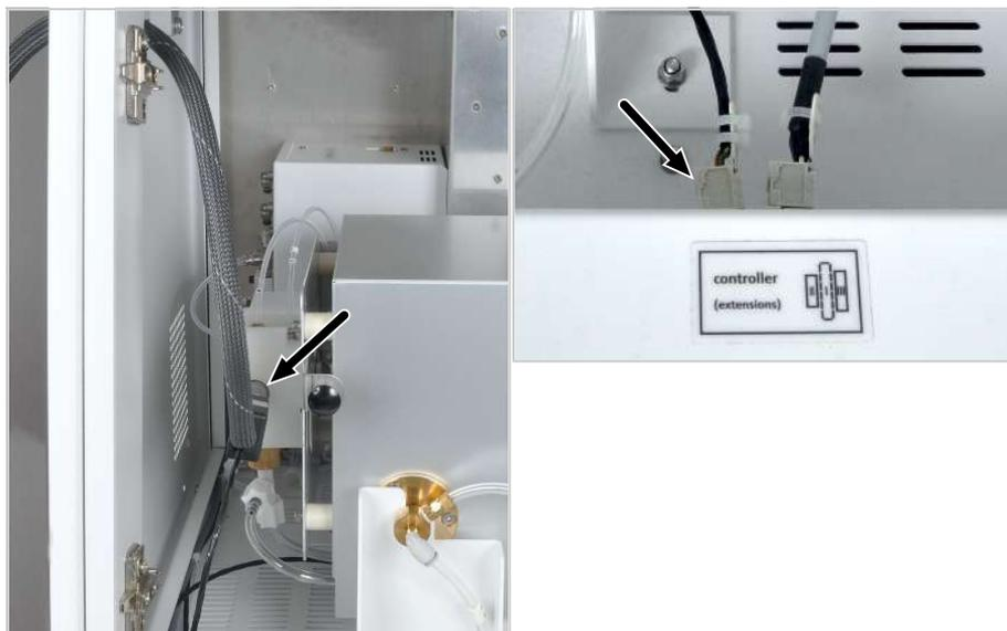
**Fig. 42 Raccord de la conduite de transfert de gaz dans le module de base**
