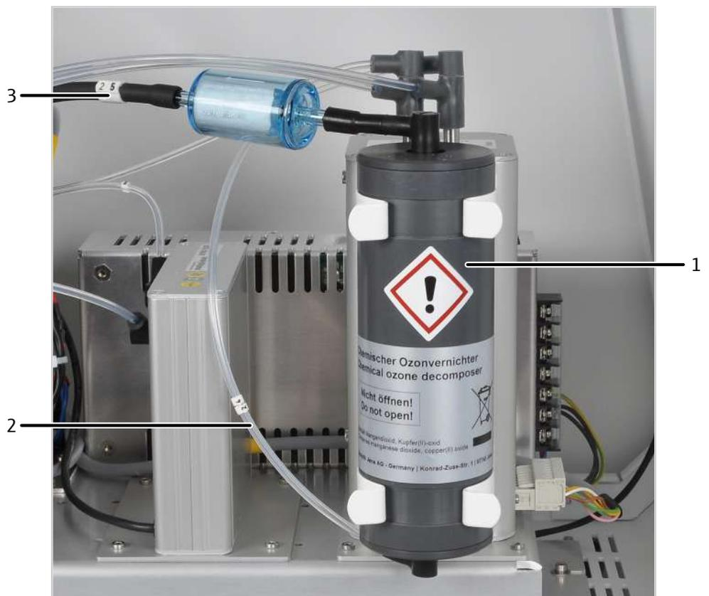
**Fig. 70 Remplacer le destructeur chimique d'ozone**
