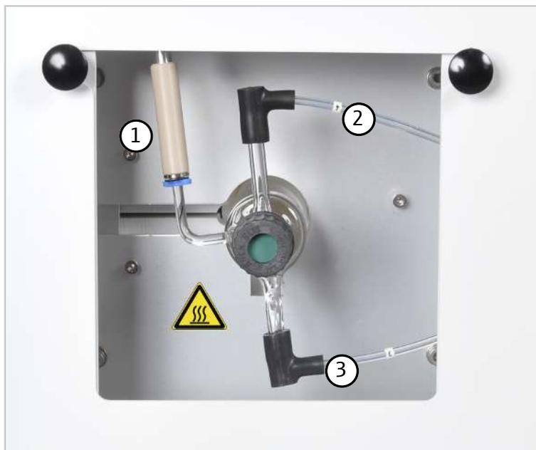
**Fig. 14** Conexiones en el tubo de combustión
