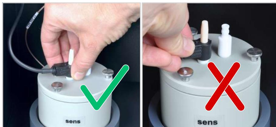
**Fig. 72 Manejar el electrodo combinado correctamente**
