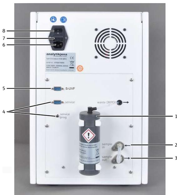
**Fig. 44 Lado trasero del detector de azufre**
