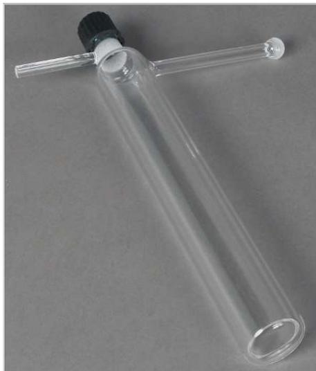
**Fig. 58 Tubo de combustión TOC (sin relleno)**
