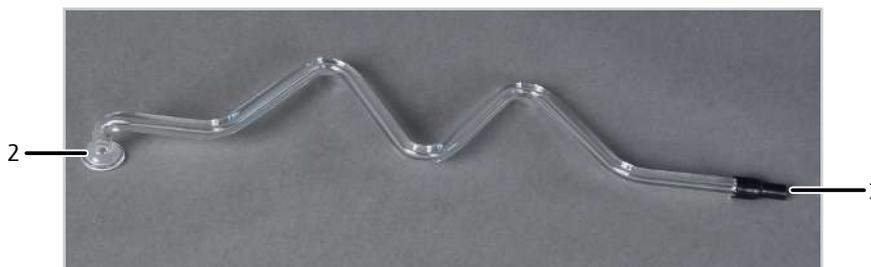
**Fig. 60 Serpentín de condensación**
