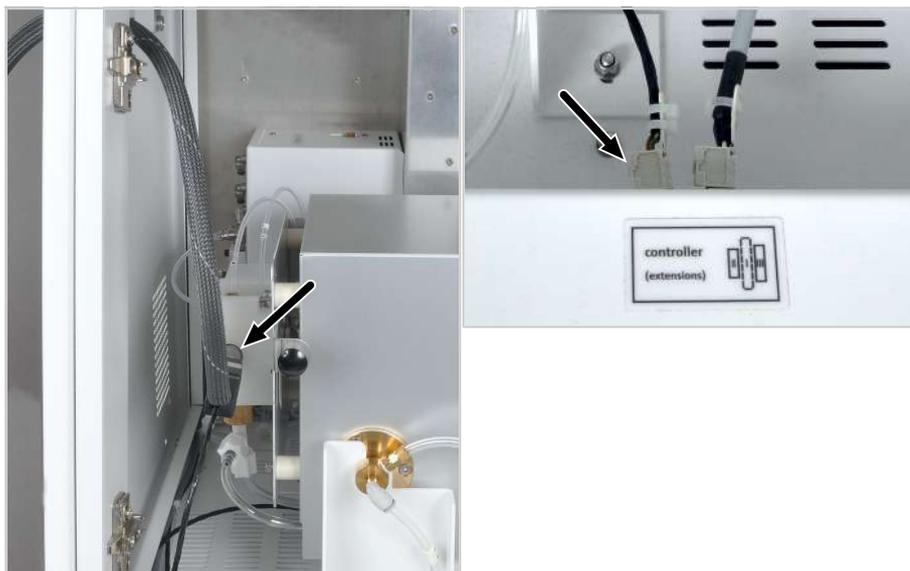
**Fig. 42 Conexión de la línea de transferencia de gas al módulo base**
