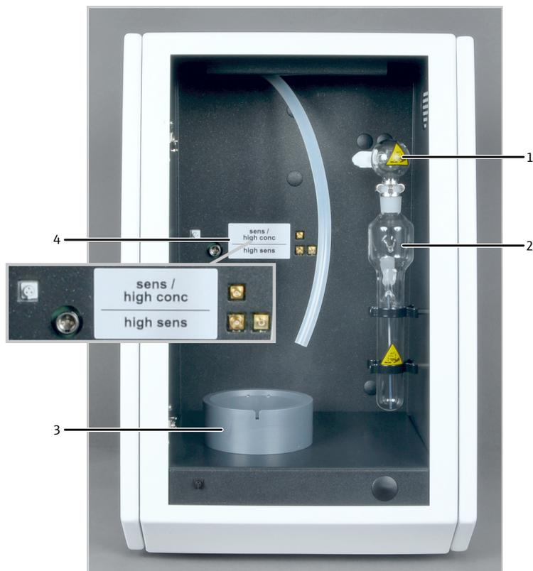
**Fig. 25 Estructura del detector de cloro (sin célula de medición)**
