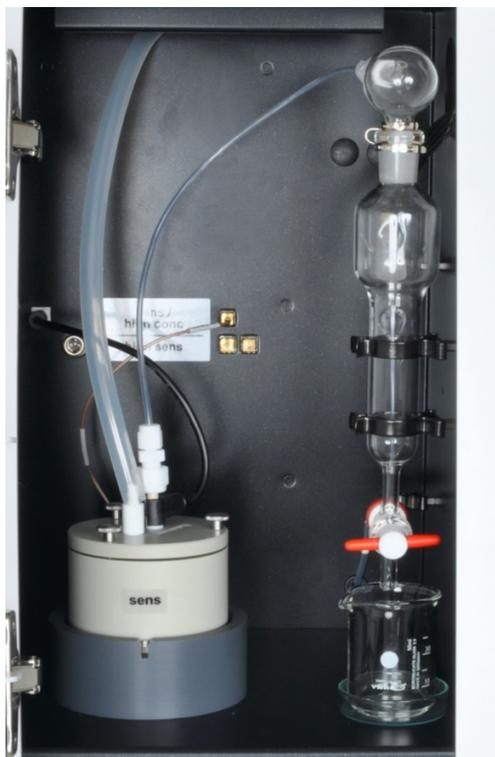
**Fig. 40** La introducción de gas en la célula de medición "sensitive"
