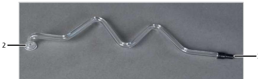
**Fig. 60 Serpentin de condensación**
