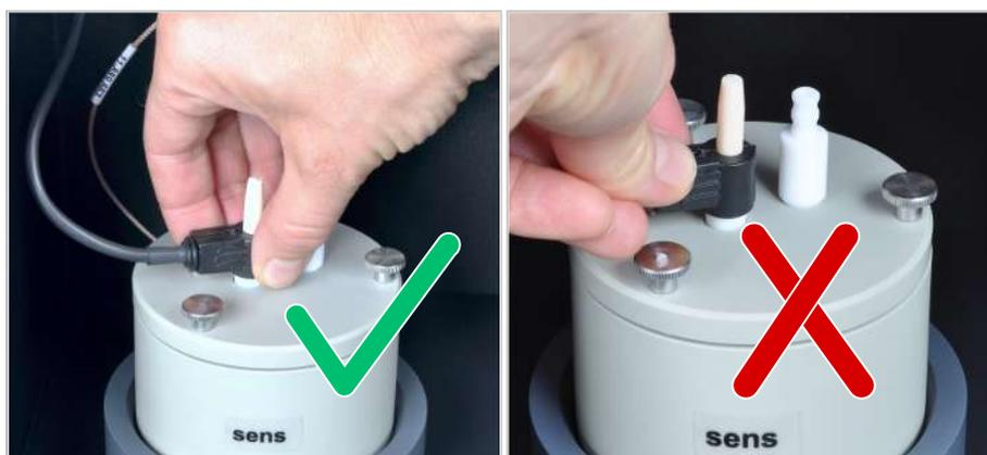
**Fig. 72 Manejar el electrodo combinado correctamente**
