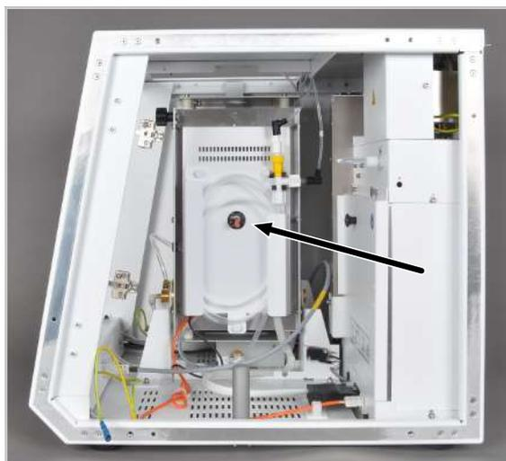
Fig. 17 Secador de membrana
