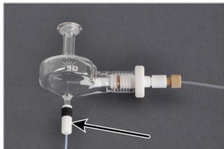
3. Fijar la manguera para residuos a la cámara de pulverización. Fijar la manguera de residuos con el adaptador a la manguera de bombeo (violeta - naranja). Fijar la manguera más gruesa al otro lado de la manguera de bombeo e introducirla en el recipiente de residuos.
