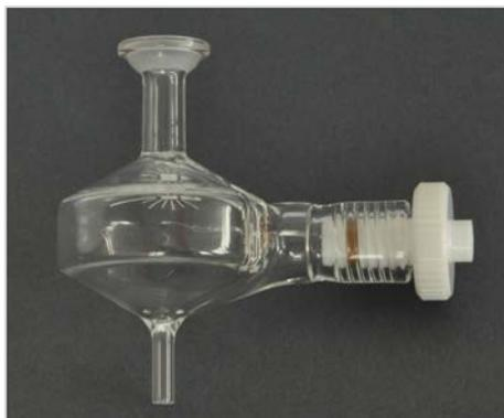
Fig. 2 Cámara de pulverización ciclónica de 20 mL
