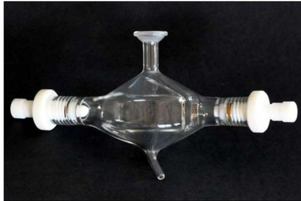
Fig. 2 Chambre de nébulisation cyclonique 50 mL avec deux entrées
