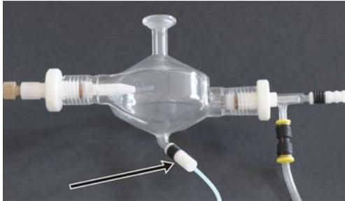
6. Fixer le tuyau de déchets sur la chambre de nébulisation. Fixer le tuyau de déchets avec l'adaptateur sur le tuyau de la pompe (violet – orange). Fixer le tuyau plus épais sur l'autre côté du tuyau de la pompe et le guider jusqu'à la poubelle de collecte.
