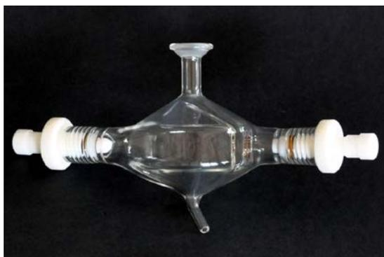
Fig. 2 Cámara de pulverización ciclónica de 50 mL con 2 entradas
