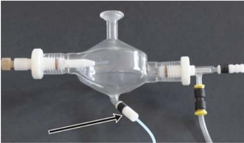
6. Fijar la manguera para residuos a la cámara de pulverización. Fijar la manguera de residuos con el adaptador a la manguera de bombeo (violeta – naranja). Fijar la manguera más gruesa al otro lado de la manguera de bombeo e introducirla en el recipiente de residuos.
