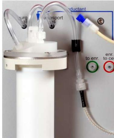
**Fig. 14 Câblage pour le mode de fonctionnement « Hydride »/« Hg sans enrichissement »**
