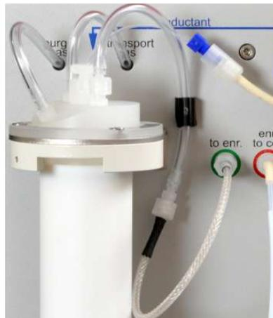
**Fig. 15 Câblage pour le mode de fonctionnement « Hg avec enrichissement »**
