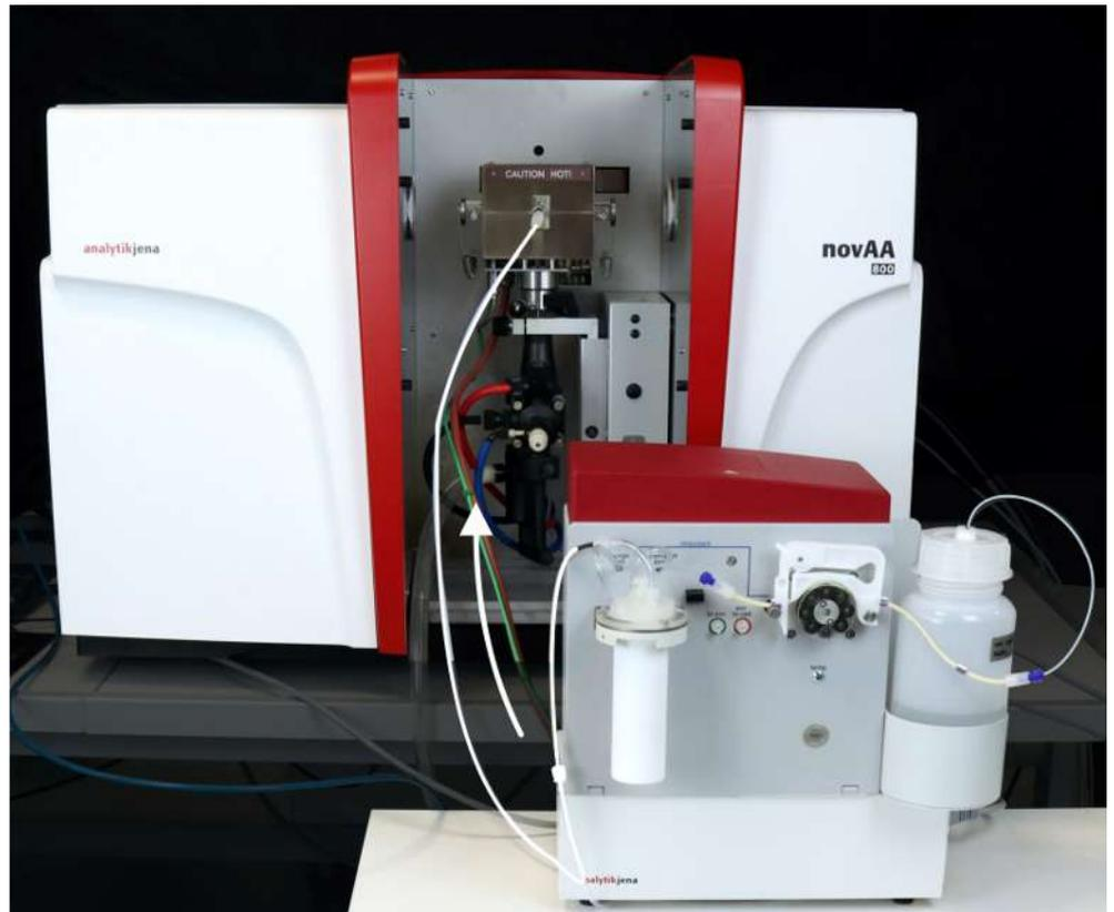
**Fig. 1** Système Hg/hydrure avec appareil AAS
