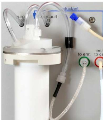
Fig. 17 Câblage pour le mode de fonctionnement « Hg avec enrichissement »
