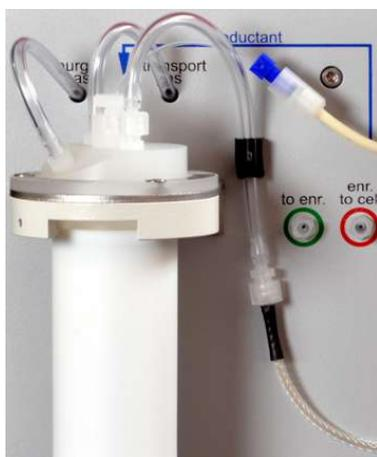
**Fig. 16 Câblage pour le mode de fonctionnement « Hydride »/« Hg sans enrichissement »**
