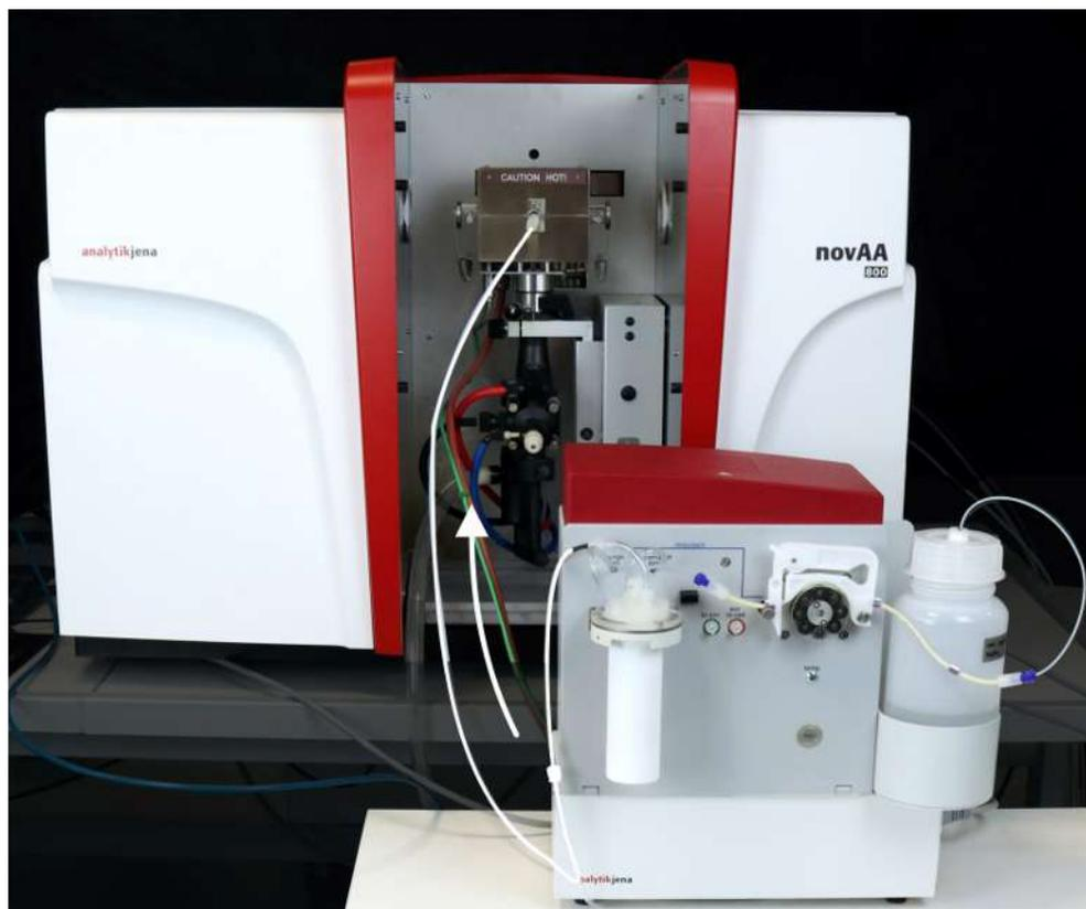
**Fig. 12** Système Hg/hydrure installé sur l'AAS
