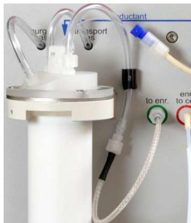
**Abb. 15 Verschlauchung für Betriebsart "Hg mit Anreicherung"**
