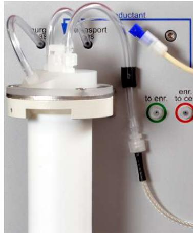
**Abb. 14 Verschlauchung für Betriebsart "Hybrid"/"Hg ohne Anreicherung"**
