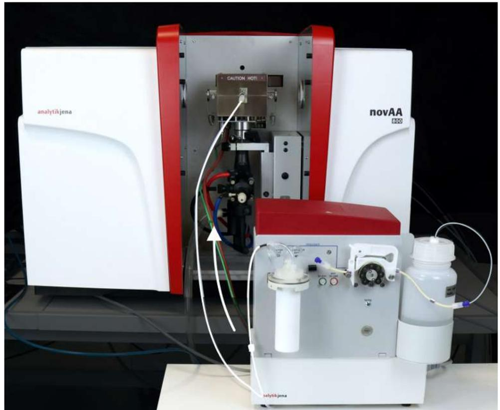
**Abb. 12 Hg/Hydrid-System am AAS-Gerät installiert**
