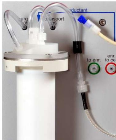
**Abb. 16 Verschlauchung für Betriebsart "Hydrid"/"Hg ohne Anreicherung"**
