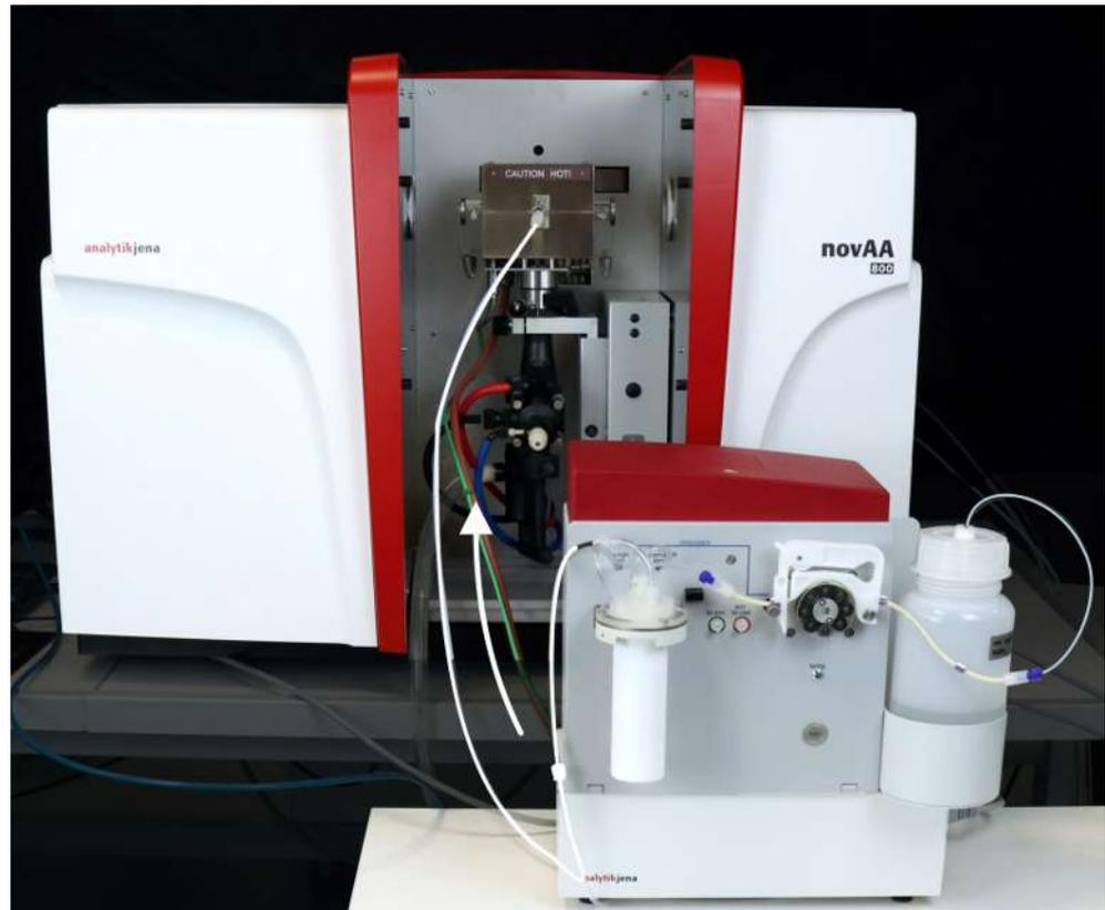
**Abb. 1** Hg/Hybrid-System mit AAS-Gerät
