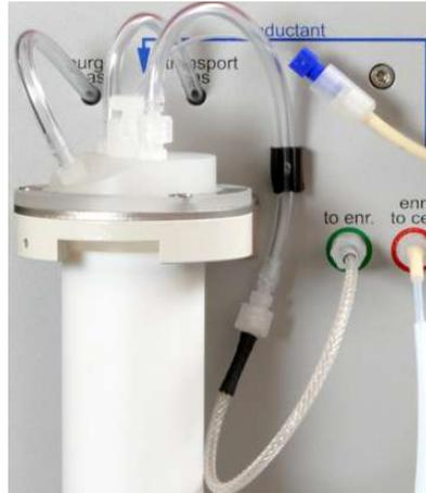
Abb. 17 Verschlauchung für Betriebsart "Hg mit Anreicherung"
