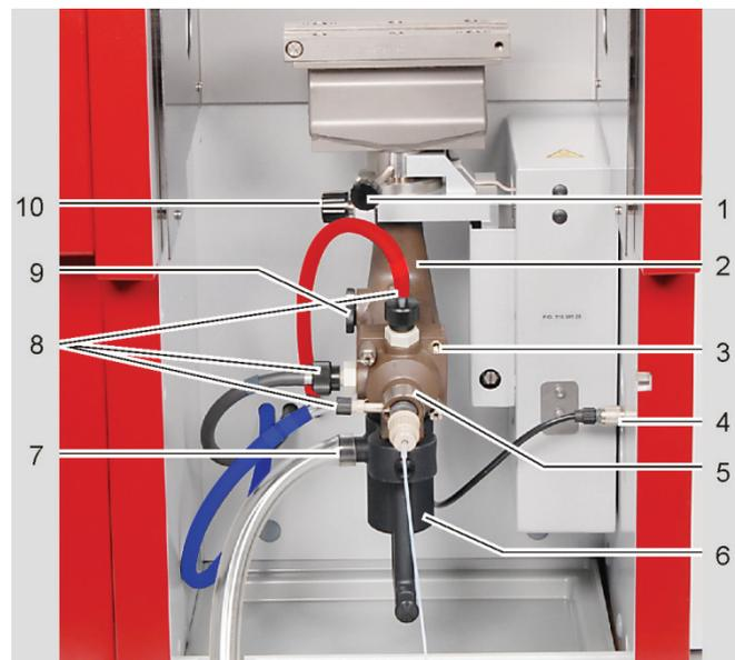
**Bild 58 Brenner-Zerstäuber-System ausbauen und zerlegen**
