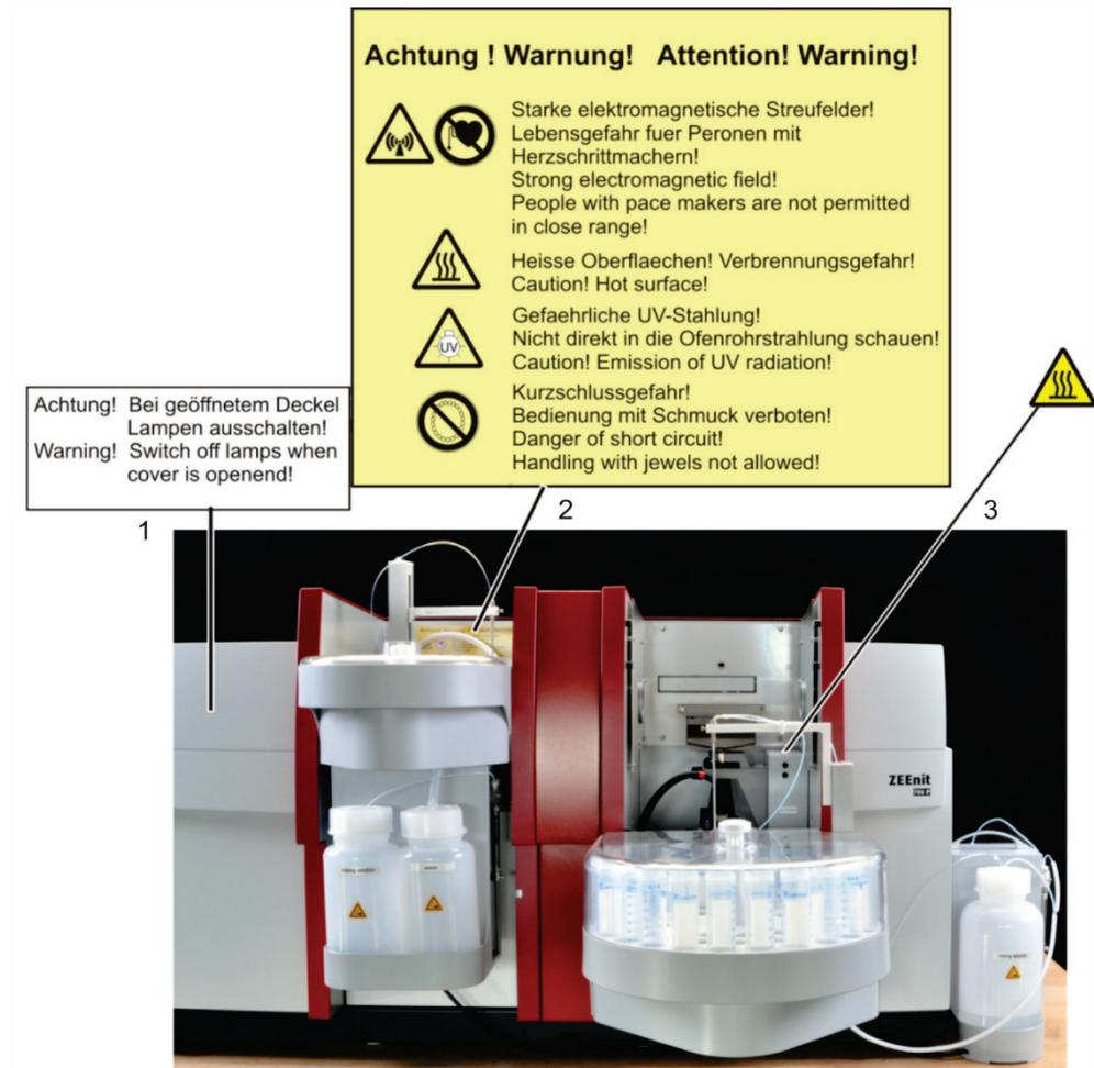
**Bild 1** Sicherheitskennzeichnung auf der Gerätevorderseite
