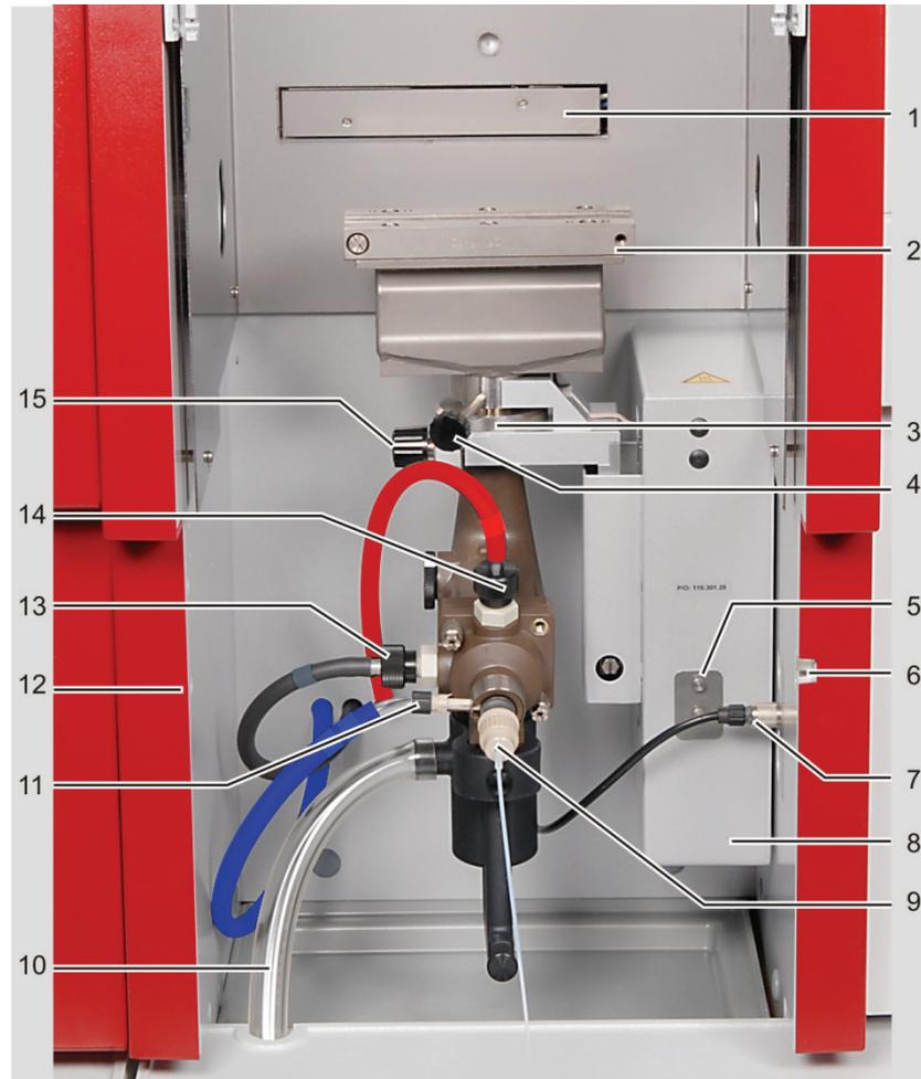
**Bild 38** Anschlüsse am Brenner-Zerstäubersystem
