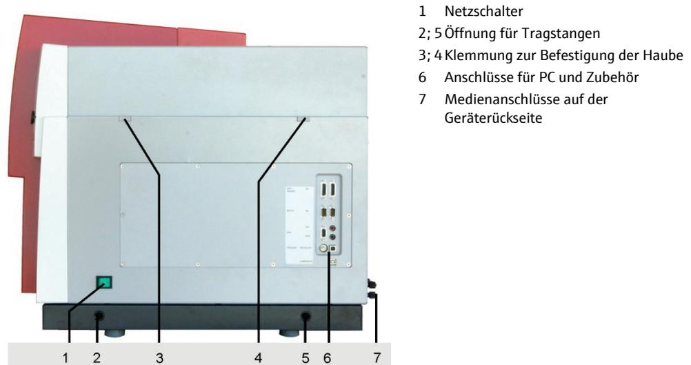
Bild 22 Netzschalter und Leiste für Versorgungs- und Steueranschlüsse
