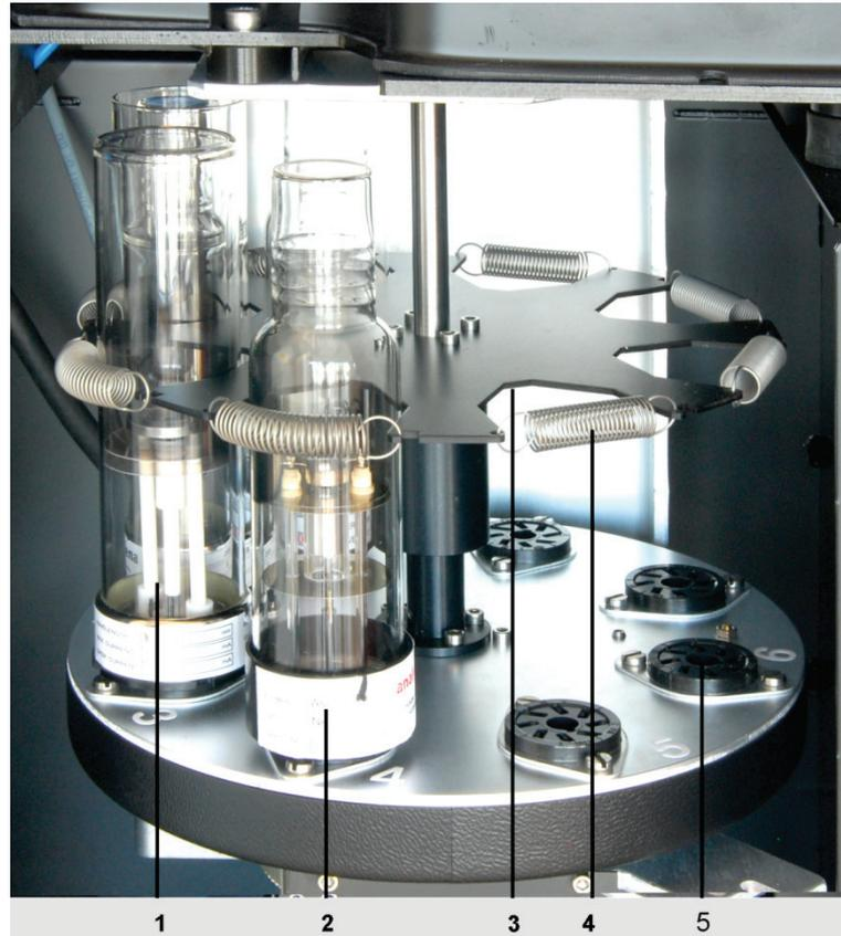
Bild 26 Aufbau des Lampenwechslers
