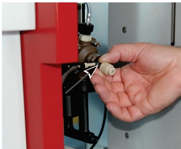
Bild 60 Zerstäuber aus der Mischkammer herausziehen
