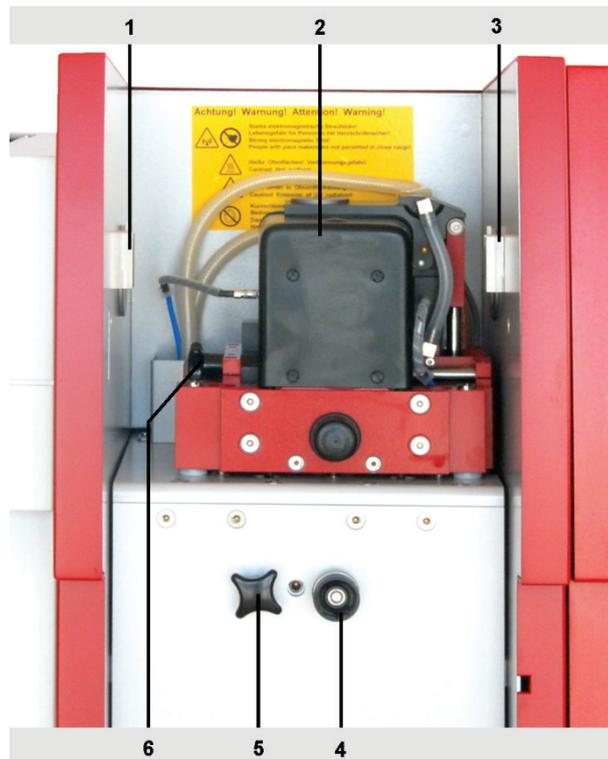
Bild 32 Elemente im Probenraum für Graphitrohrtechnik
