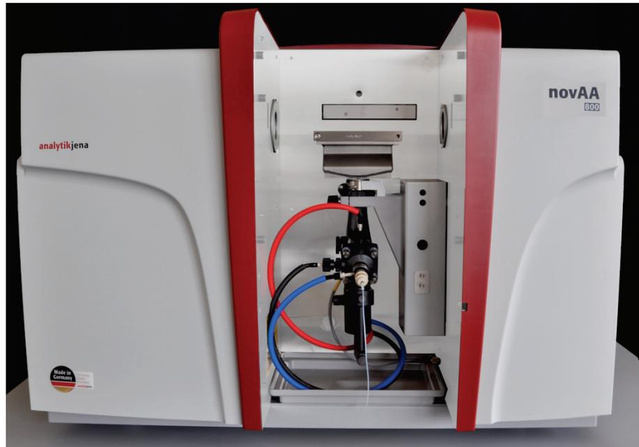
Bild 4 Probenraum des novAA 800 F
