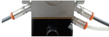
22. Die beiden weiteren Gasstutzen (für den inneren Gasstrom) beiderseits in den Ofenmantel einschrauben.
