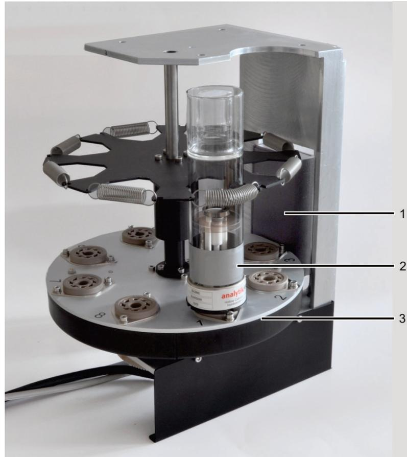
**Bild 6** Lampenwechsler mit Lesegerät
