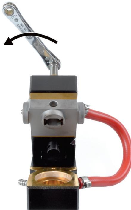
13. Die Ausdrückvorrichtung mit zurückge-drehter Spindel bis zum Anschlag in das feststehende Ofenteil schrauben.
