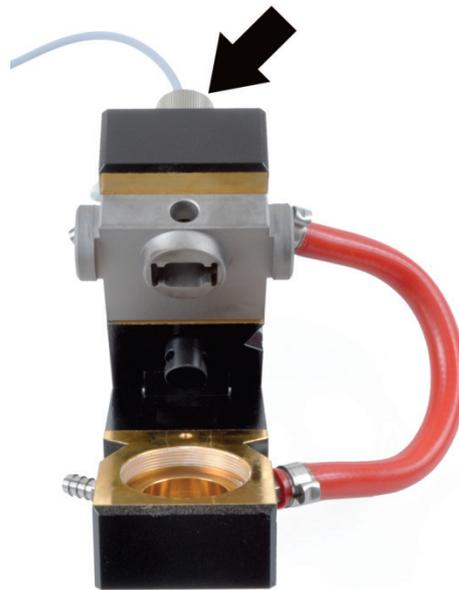
18. Die Sensorhülse für den Kühlwassertemperatursensor mit Fingerkraft in das feststehende Ofenteilschrauben.
