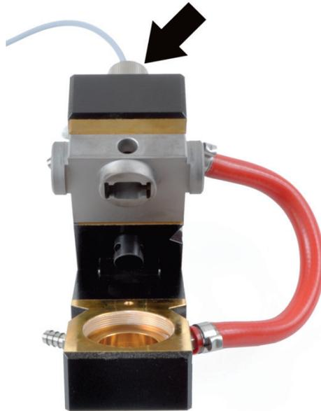
11. Die Überwurfmutter am Kühlwasser-Tempersensord lösen.
