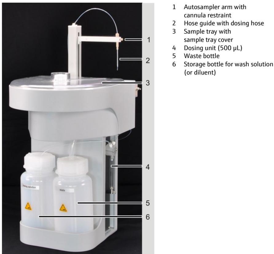
Fig. 18 Autosampler AS-GF
