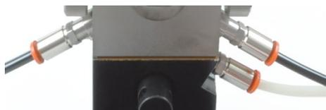
21. Avvitare i restanti due raccordi (per il flusso interno del gas) su entrambi i lati del mantello del fornello.
