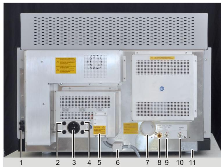
Fig. 27 Vista posteriore contrAA 800 D con collegamenti e fusibili
