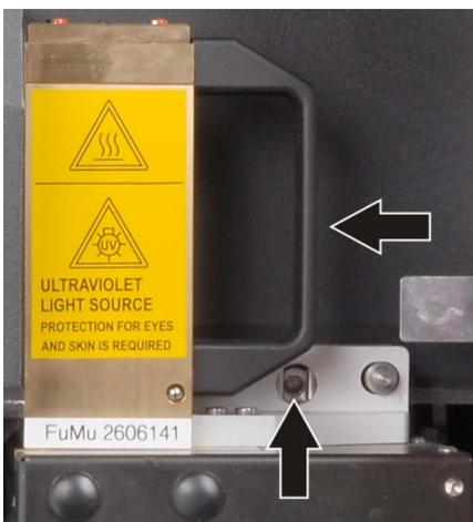
3. Utilizzando la chiave a brugola da 5 mm (in dotazione), svitare completamente la vite di fissaggio orizzontale dell'alloggiamento della lampada.
