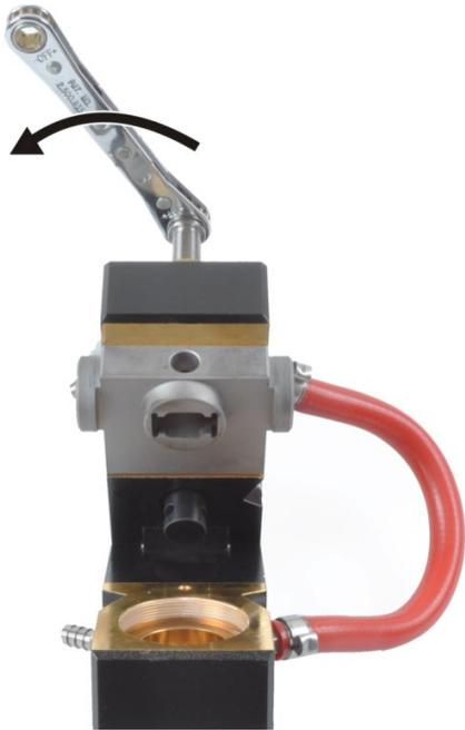
12. Avvitare il dispositivo di espulsione, con il mandrino svitato, fino alla battuta nella parte fissa del fornello.
