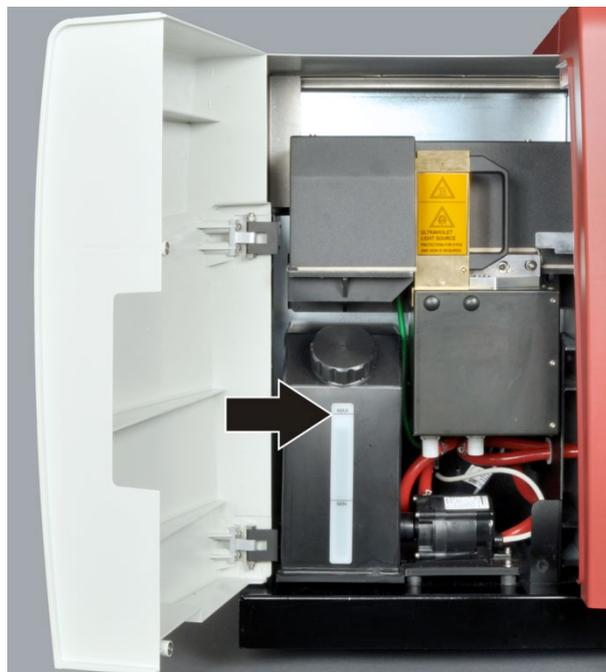
Fig. 32 Contenitore dell'acqua di raffreddamento nel vano lampada
