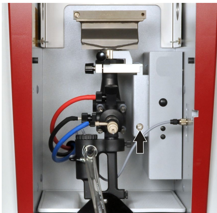
Fig. 50 Vis de réglage utilisée pour aligner l'unité d'atomisation
