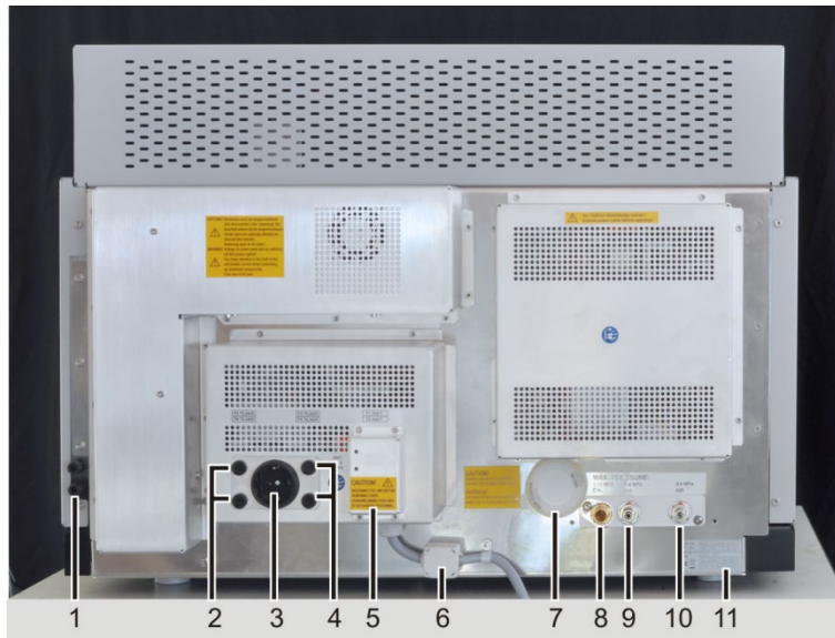
Fig. 27 Vue de derrière du contrAA 800 D avec raccords et fusibles
