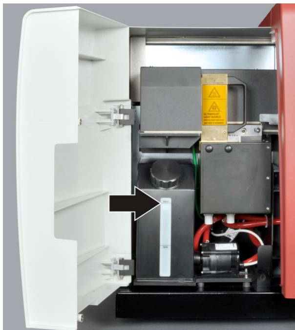
Fig. 32 Depósito de agua de refrigeración en el compartimento de la lámpara
