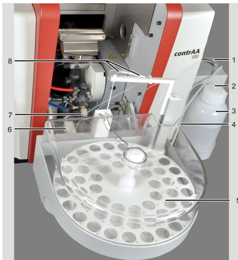
Fig. 43 tecnología de llama, con automuestreadores AS-FD y SFS 6
