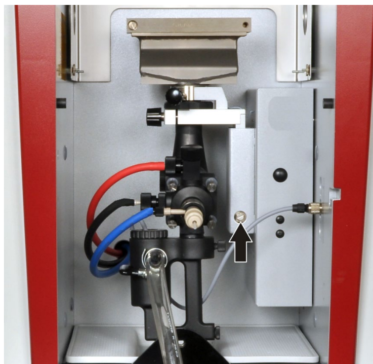
Fig. 50 Tornillo de ajuste para la alineación de la unidad de atomización
