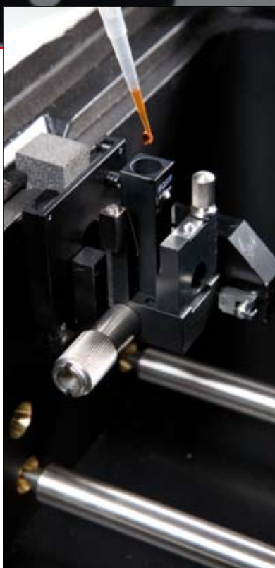
Echantillonneur automatique pour un débit des échantillons particulièrement élevé
