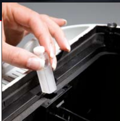
Position pour les échantillons troubles pour la mesure d'échantillons à forte diffusion
