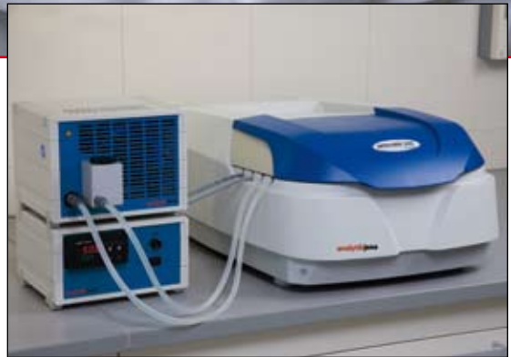
Tourelle à 8 cuvettes à refroidissement Peltier pour des analyses effectuées à la température exacte
