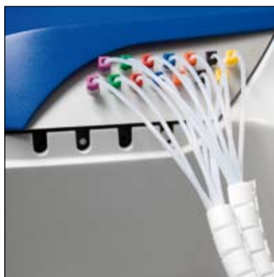
Le SPECORD® PLUS Dissolution permet d'étudier la libération des substances actives dans des pastilles pendant le processus de dissolution.
